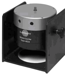
Şekil 4.5 : B&K 4824 model sallayıcı [12].
