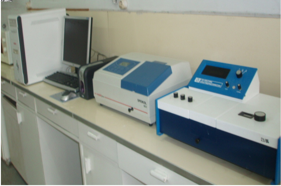
Resim 3.5. Aroma Maddeleri, Alkol ve Tirozin Tayininde Kullanılan Spektrofotometreler
