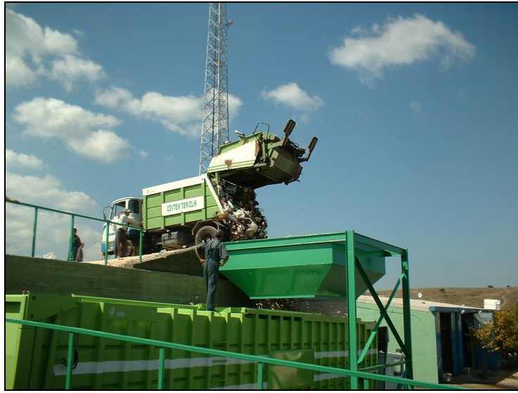
Şekil 4.6 : Yatay sıkıştırma kasaya örnek. (Demir, 2005)
