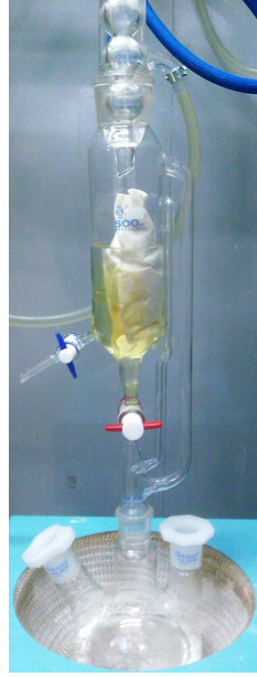
Şekil 4.7 Küçük ölçekli ekstraktör görüntüsü
