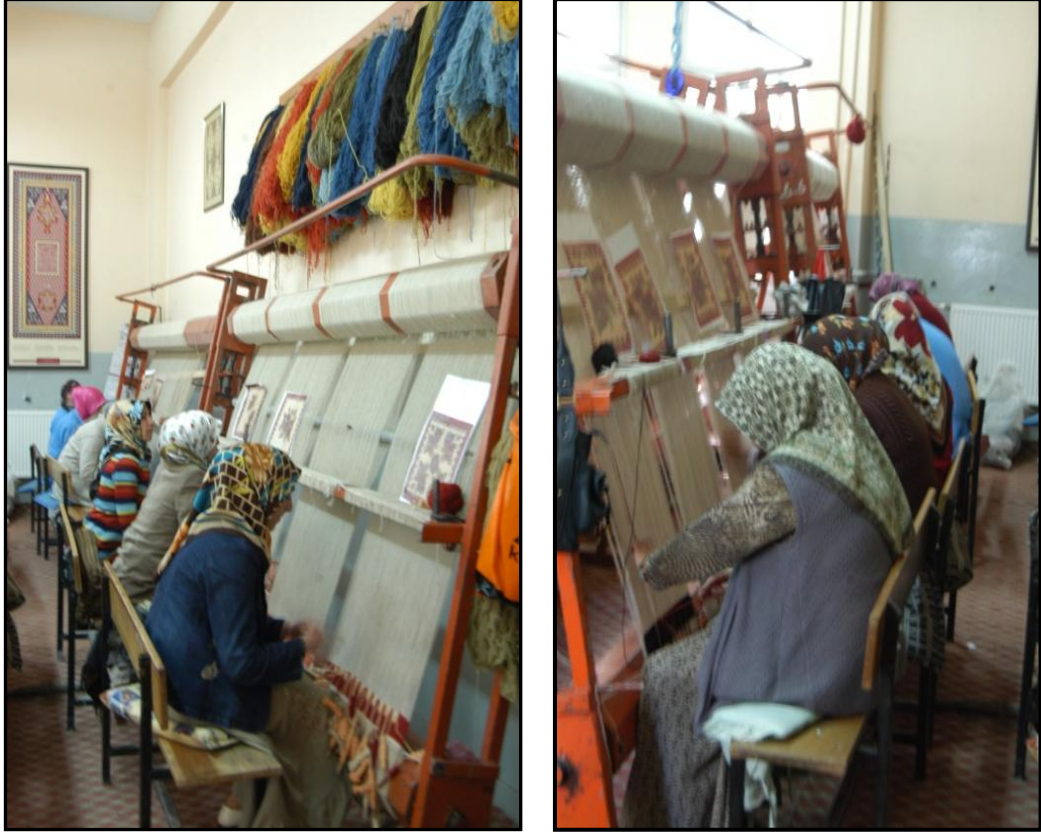
Foto.: 56 – 57 Dikey Tezgâhta Kilim Dokunurken (Sarıkamış Dokuma Atölyesi)
