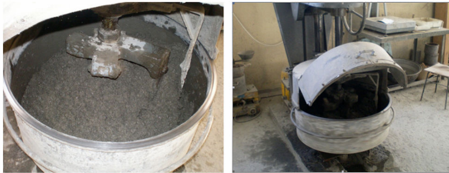
Şekil 4.3: Beton Karışımının Hazırlanması
