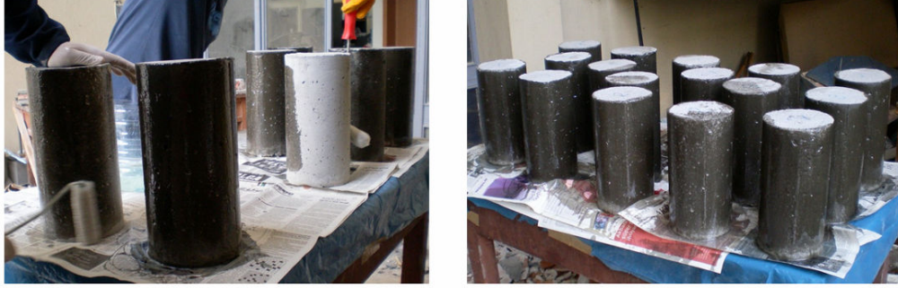
Şekil 4.6: Numunelerin Primer Malzemesi ile Kaplanması
