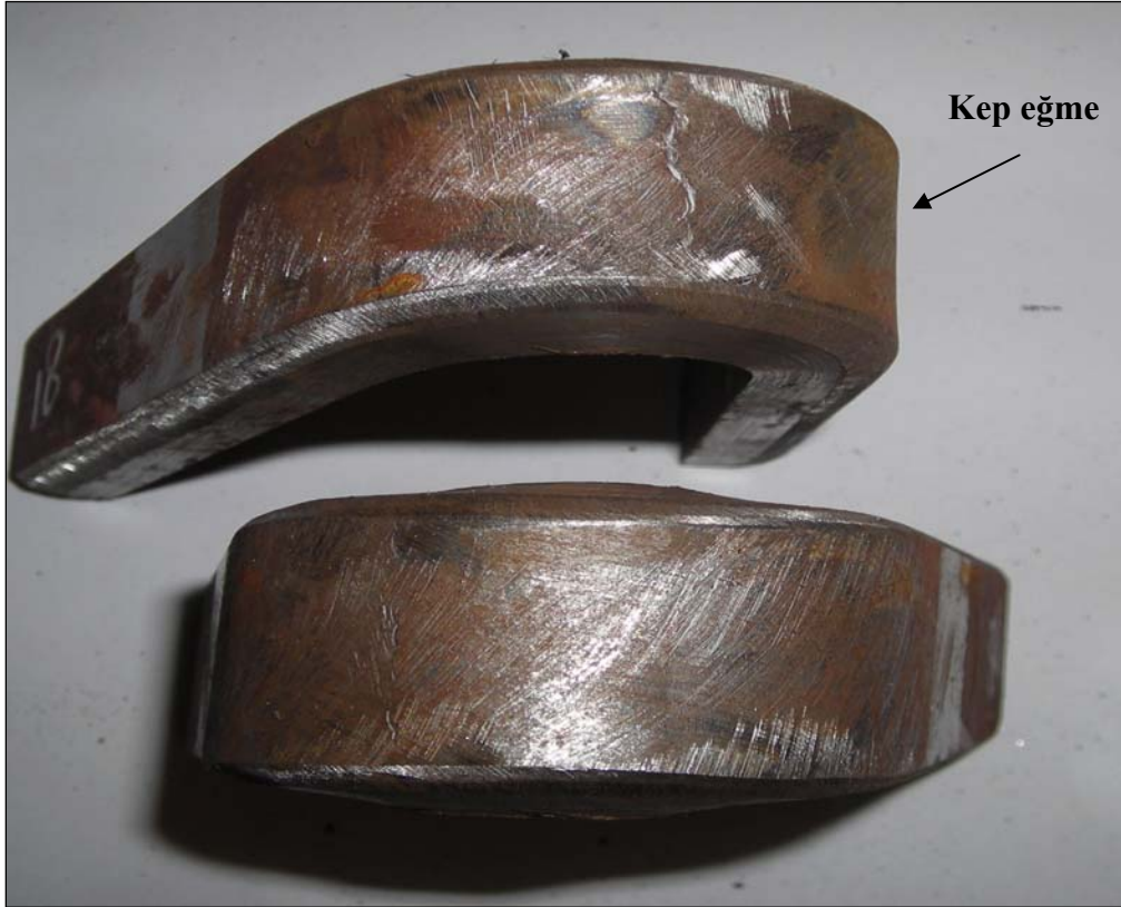
Şekil 10.26 Kep eğme de çatlak meydana gelen 18 nolu numune (AH36 3G E R).
