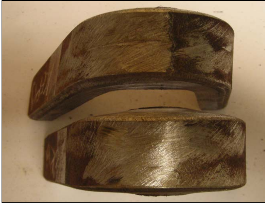
Şekil 10.24 Hasara uğramamış 19 nolu numune (AH36 3G E B).
