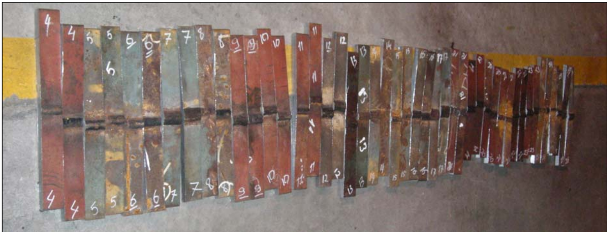
Şekil 9.6 Kaba ölçülerde kesilen çekme ve eğme numuneleri.
