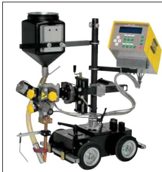
Şekil 9.3 ESAB A2 Multitrac A6 PEH kontrollü tel sürme ünitesi (ESAB 2009).
