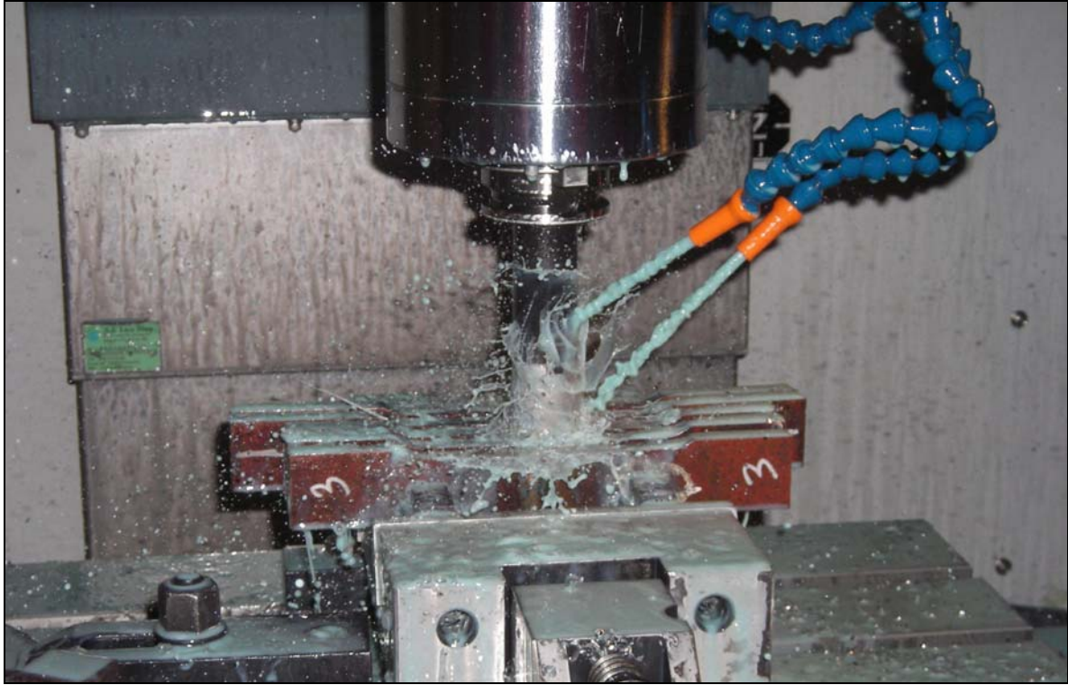
Şekil 9.8 Çekme numunelerinin bor soğutma sıvısı kullanılarak CNC tezgahında işlenmesi.
