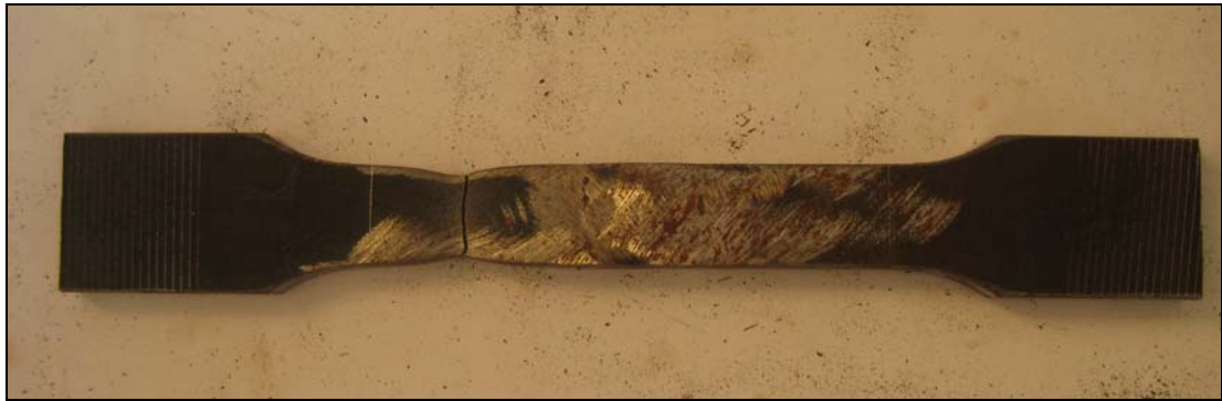
Şekil 10.20 Ana metalden kopan çekme numunesi örneği (No.19 AH36 3G E B).
