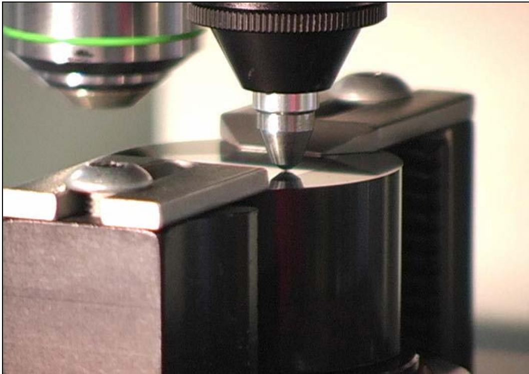
Şekil 8.19 Mikrosertlik deneyinin yapılışı (URL-11).
