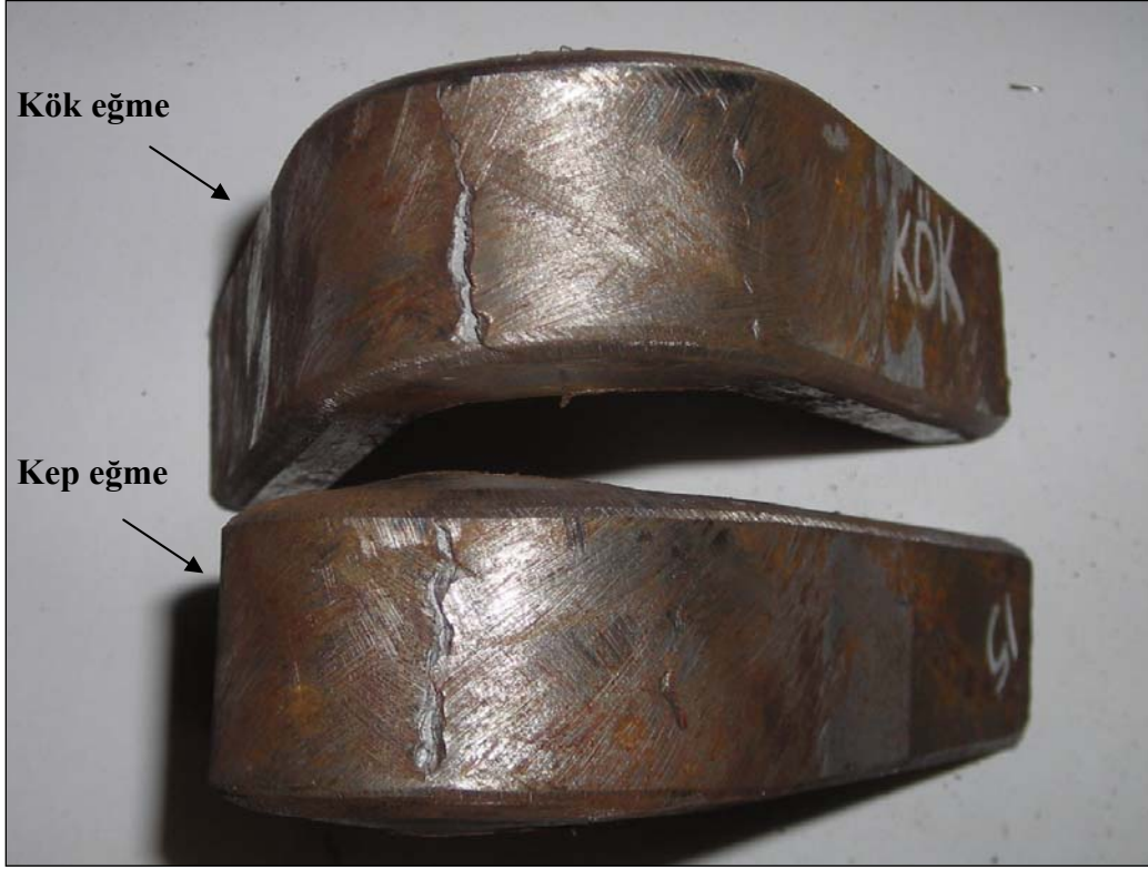
Şekil 10.25 Hem kök hem de kep eğmede çatlak meydana gelen 15 nolu numune (DH36 3G E R).
