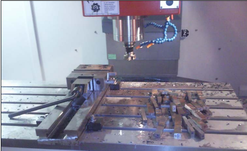
Şekil 9.11 Çentik darbe numunelerinin hazırlanma aşaması.
