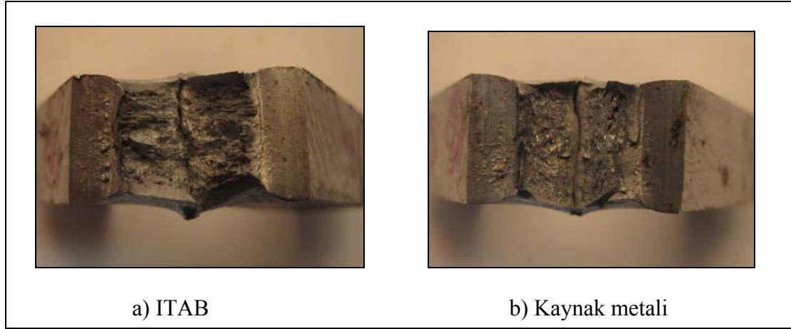
Şekil B.2 2 Nolu numune (DH36 1G E B) ITAB ve kaynak metali kırılma yüzeyleri.
