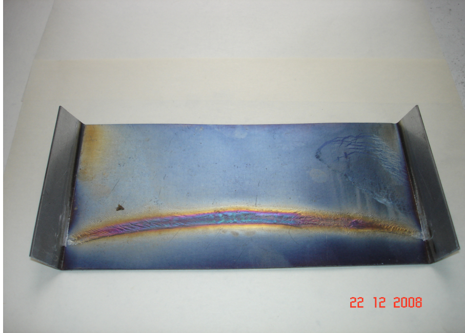
Şekil 4.15 : Elektrikli ısıtma sonrasında Al-Si kaplamanın ergimiş hali.
