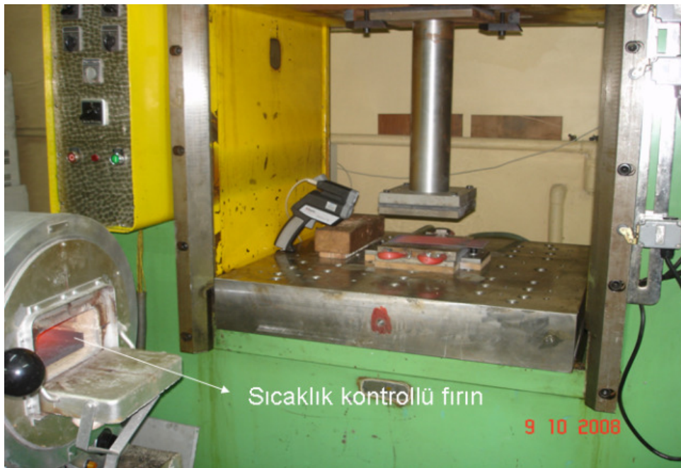
Şekil 4.4 : Fırında ısıtma ile preste sertleştirme deney düzeneği.
