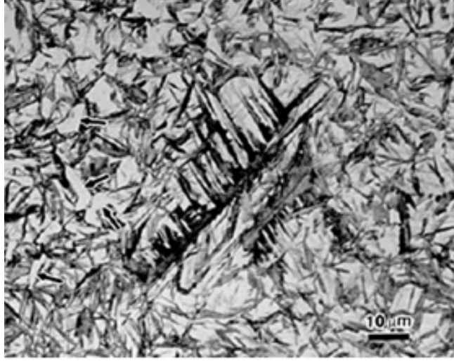
Şekil 3.7 : Plaka martensit mikroyapı görüntüsü [3].
