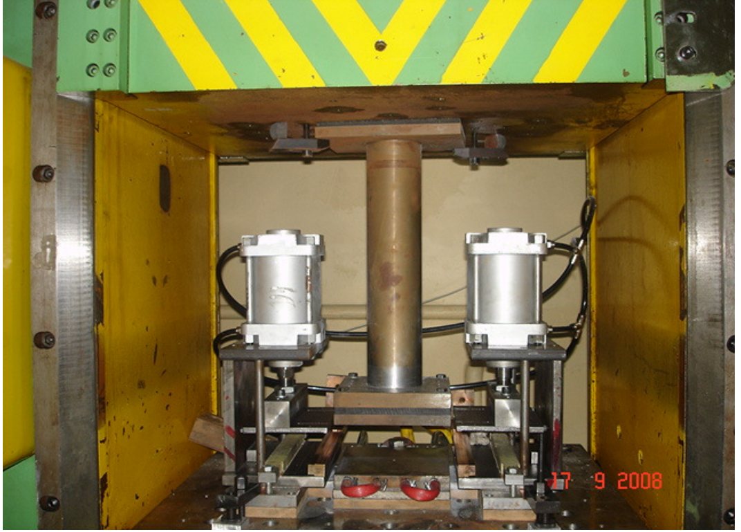
Şekil 4.9 : Elektrikli ısıtma ile preste sertleştirme deney düzeneği (elektrod tutucu).
