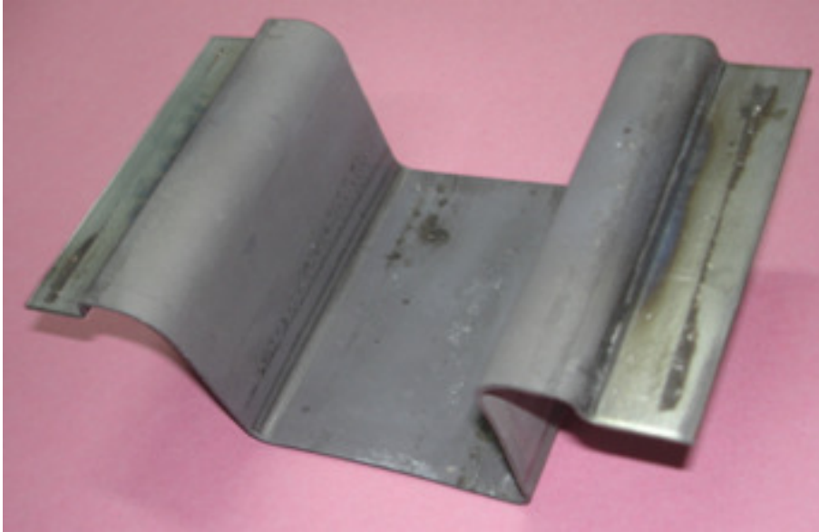
Şekil 4.17 : Termo-mekanik işlem ile şekillendirilmiş açık U kanal profil.
