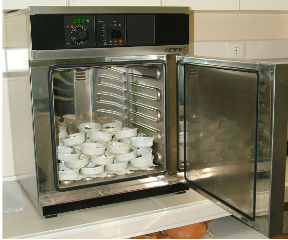
Şekil 3.8. Meyve örneklerindeki su miktarının saptanması
