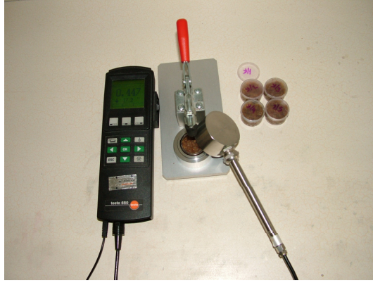
Şekil 3.7. Hazırlanan örneklerde su aktivitesi ölçümü
