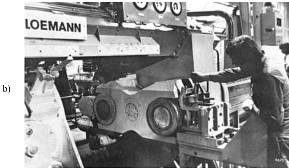
Şekil 2.12. Kalıp tutucu sistem: a) kalıp sürgüsü, b) döner kalıp başlığı.
