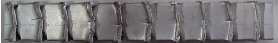
Şekil 4.1. Ekstrüzyonda oluşan hız çatlağı (Mes Makine A.Ş.)
