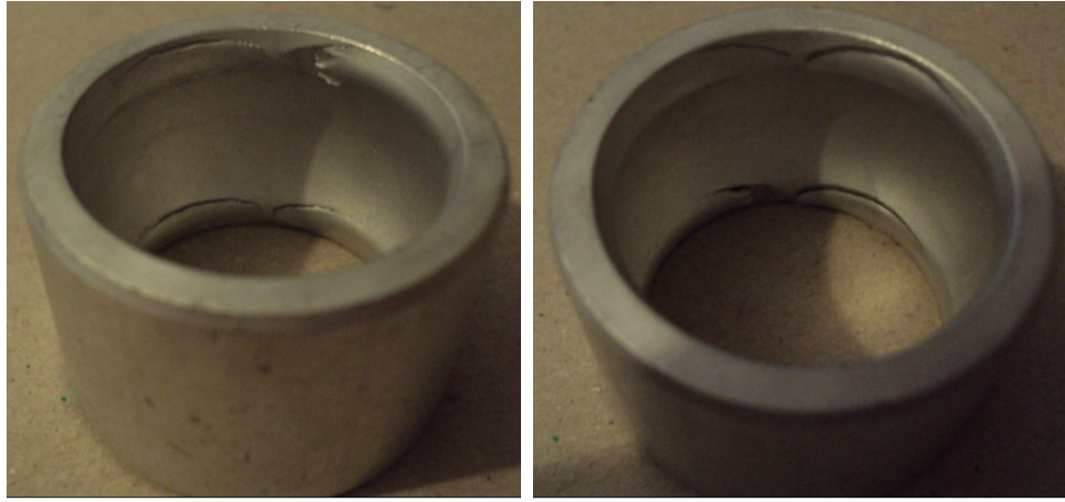
Şekil 4.3. Boru ekstrüzyonunda iç hatalar (Mes Makine A.Ş.)
