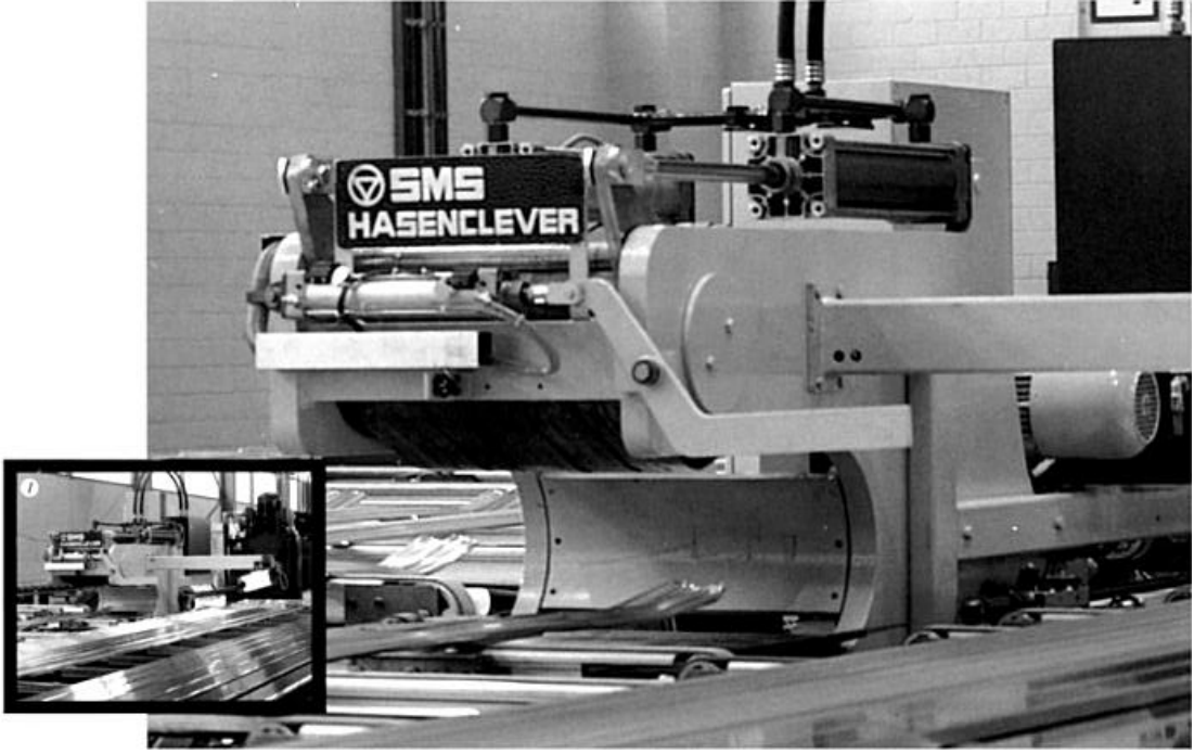
Şekil 2.20. Gerdirme düzeneği arka çenesi. (1) Gerdirme düzeneği ön çenesi [Saha,2000].
