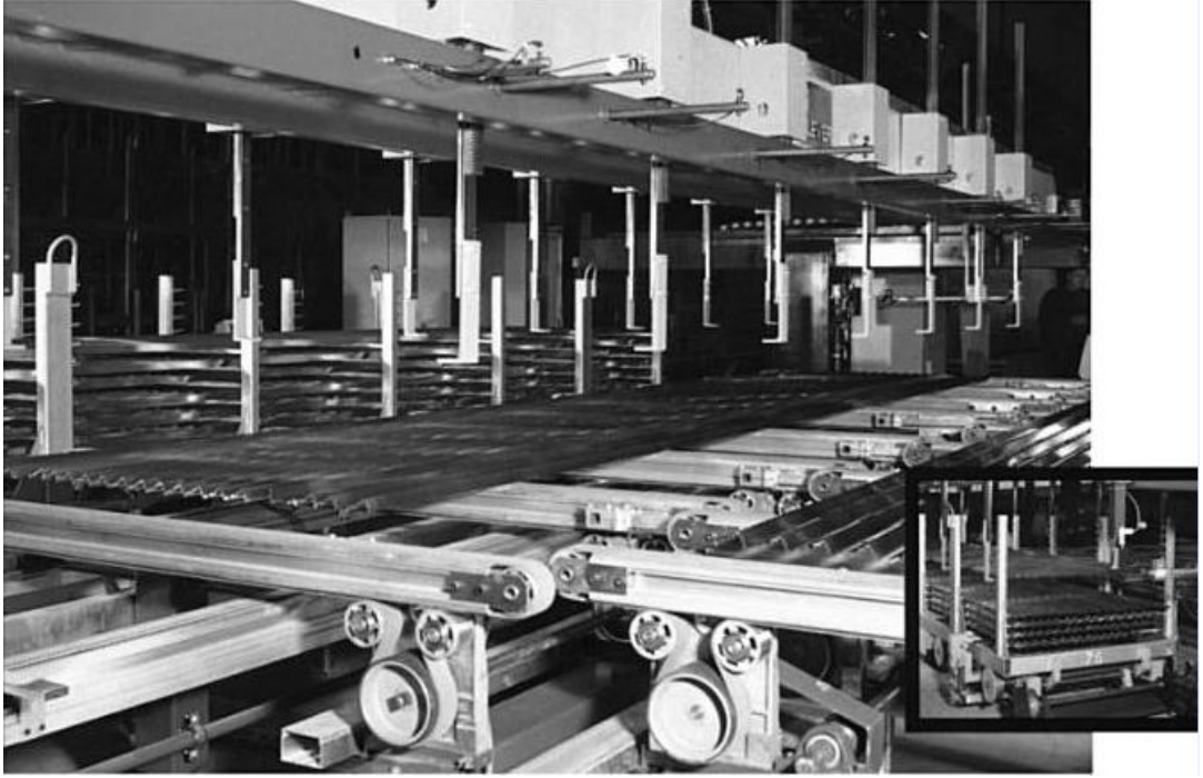
Şekil 2.21. Otomatik profil istifleme düzeneği. (1) Profil sepetine profillerin istiflenmesi [Saha,2000].
