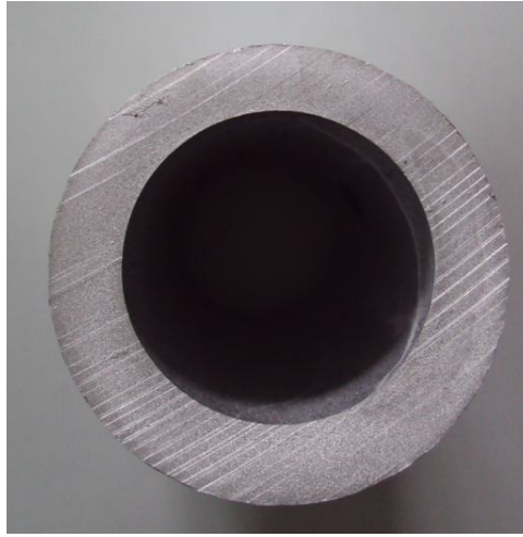
Şekil 4.2. Boru ekstrüzyonunda salgılı ürün (Mes Makine A.Ş.)
