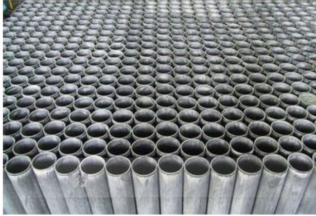
Şekil 2.6. Püskürtmeli ekstrüzyon yöntemi ile üretilmiş basınçlı tüpler ( www.mesaluminium.com )
