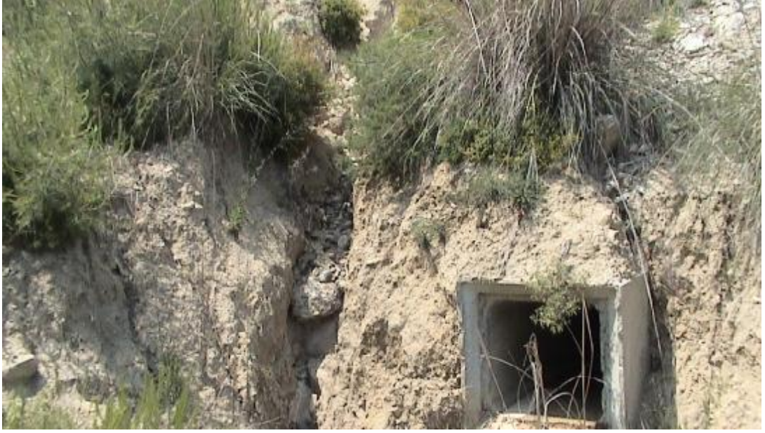
Şekil 4.13. Çalışma alanındaki borulanmaya bir örnek.
