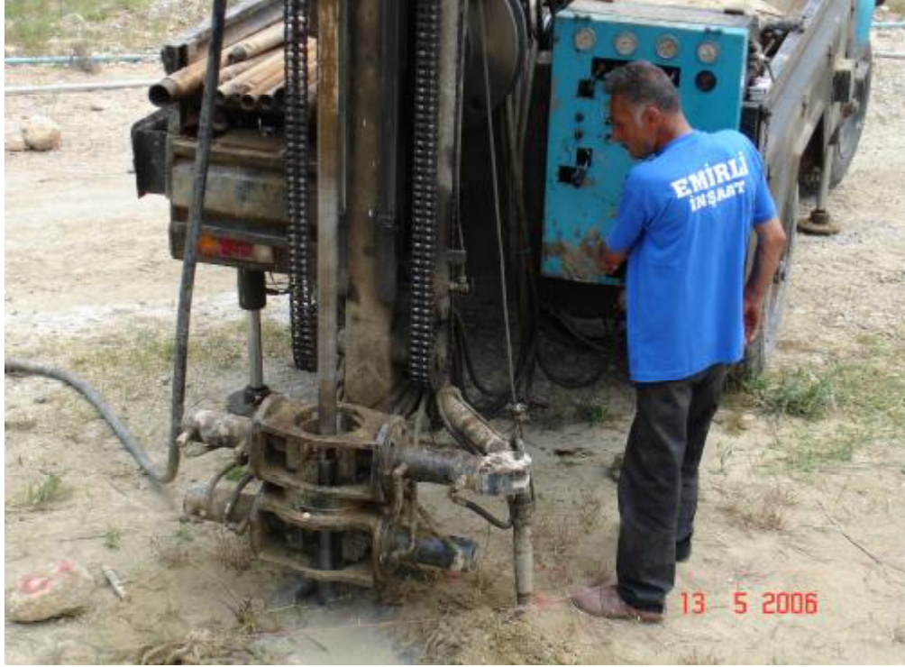
Şekil 4.7. Karotlu sondaj numunesi alma işlemi.
