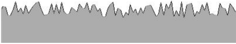
Şekil 2.1 Yüzey pürüzlülüğü örneği
