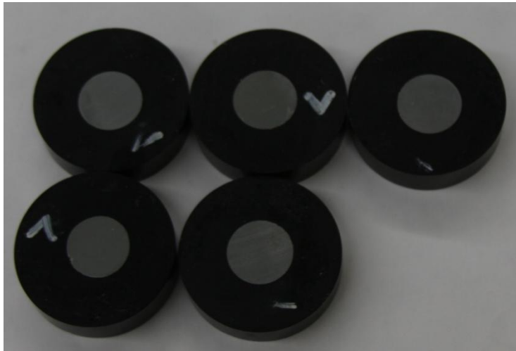
Şekil 4.4 Pürüzlülüğü 0.14 ile 0.45 \mu\text{m} arasında değişen yüzeyler
