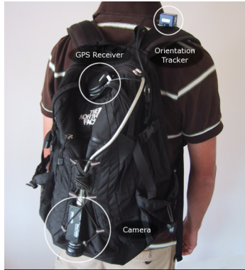
Şekil 1.1 : Sırt çantasına bağlanan kamera ile lokalizasyonun tespit edilmesi
