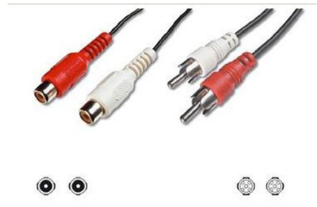
Şekil 2.3 : Örnek CINCH bağlantı kablosu (2 x Cinch erkek , 2 x Cinch dişi)
