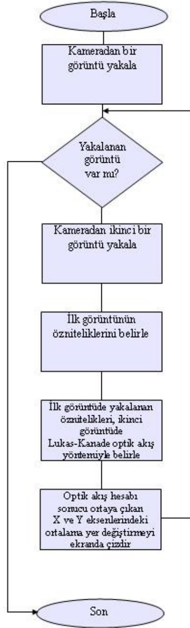
Şekil 2.12 : Yer belirleme için kullanılan görsel odometri algoritması
