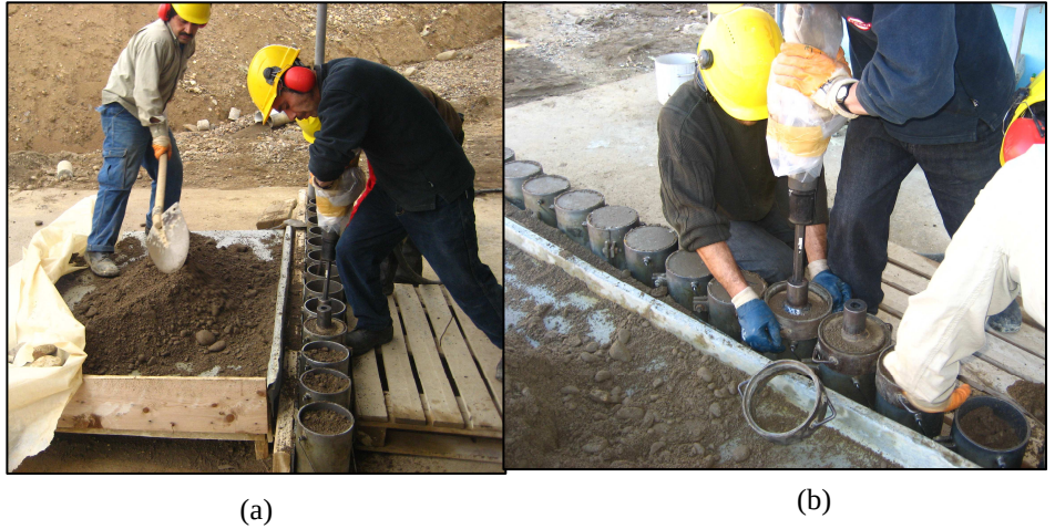
Şekil 9.5. SSB numunelerinin hazırlanması (a) SSB'nin havalı tabanca kullanılarak sıkıştırılması (b) SSB'nin son kademesinin sıkıştırılması
