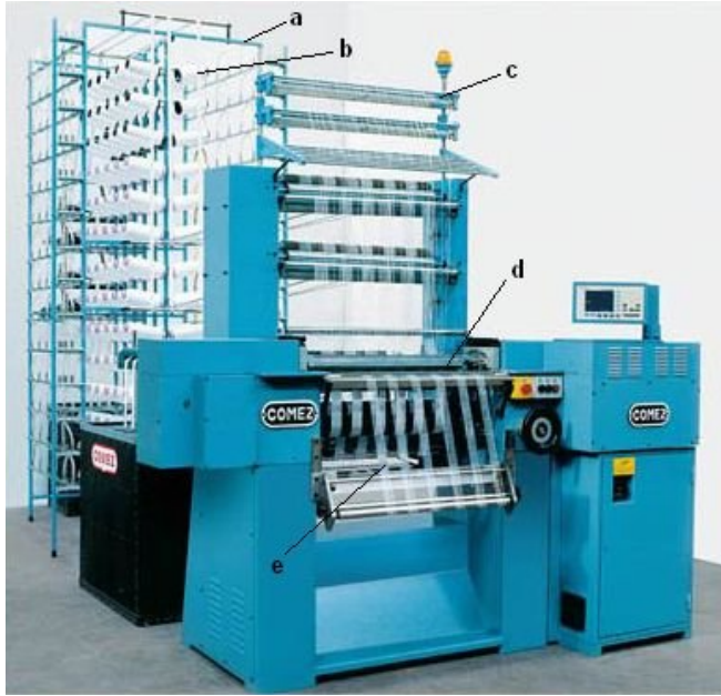
Şekil 2.5 Kroşe örgülü örme makinesi a)Bobin cağığı, b) Örgü bobinleri, c)İplik sevk ve kontrol üniteleri, d) Örme bölgesi, e)Kroşe örgülü örme bant ( http://www.comez.com/secliv-home-en.htm )
