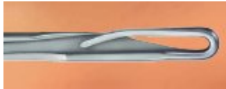
Şekil 2.7 Groz-Beckert firmasına ait, açılma ve kapanma işlemlerini kendi kendine gerçekleştiren (self operating) karbine iğne ( http://www.groz-beckert.com/website/gbkg/en/products.html )
