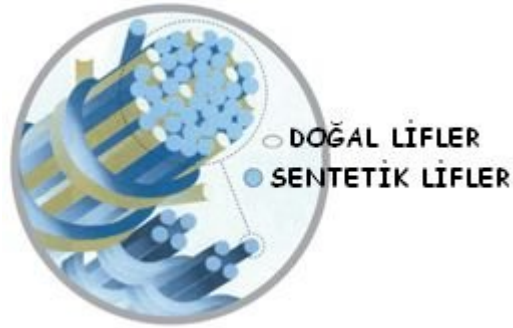
Şekil 4.1 MicBL-Pes/Co kodlu ipliğinin yapısı ( http://www.drirelease.com/hiw_un_technology.html )
