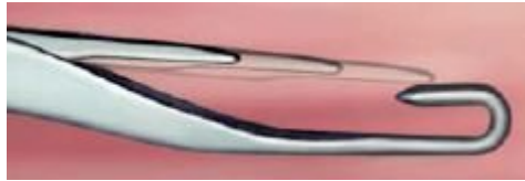
Şekil 2.9 Groz-Beckert firmasına ait sürgülü iğne ve sürgünün hareket pozisyonları ( http://www.groz-beckert.com/website/gbkg/en/products.html )
