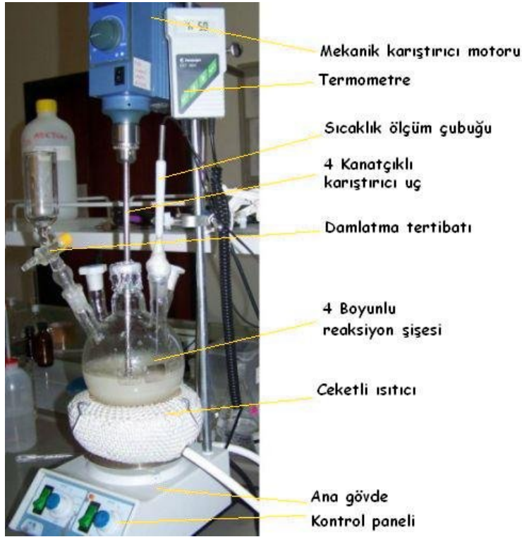
Şekil 4.17 Mikrokapsülleme işlemi için hazırlanan deney tertibatı
