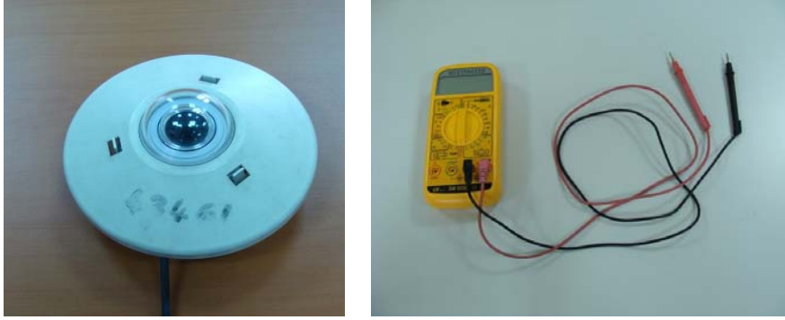
Şekil 7.10. Deneylerde ışıınımı ölçmek için kullanılan piranometre ve dijital multimetre
