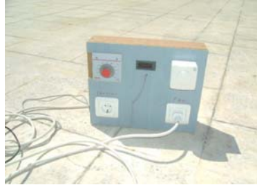
Şekil 7.1. Hava debisi ve sıcaklık kontrol paneli
