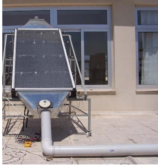
Şekil 7.115. Kıvrımlı galvaniz oluk yüzeyli hava akışkanlı güneş kolektörü test düzeneği
