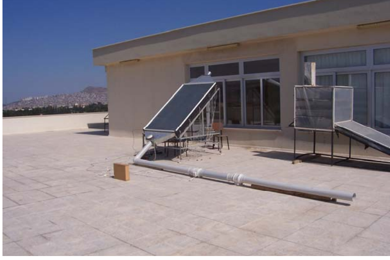
Şekil 7.12. Seçici yüzeyli hava akışkanlı güneş kolektörü test düzeneği
