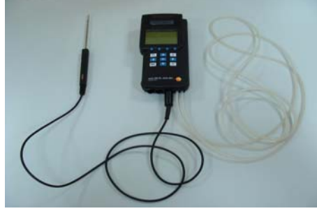
Şekil 7.9. Hava hızını ve basınç düşümünü ölçmek için kullanılan hot wire anemometre, basınç ölçüm boruları ve veri toplama cihazı
