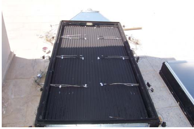
Şekil 7.114. Kıvrımlı galvaniz oluk yüzeyli kolektörde sıcaklık sensörlerinin yerleşimi
