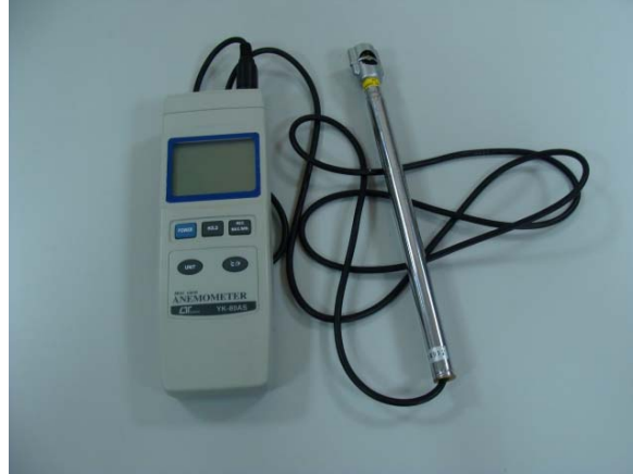
Şekil 7.3. Dış ortam sıcaklığı ve rüzgâr hızı ölçümünde kullanılan mini pervane anemometre
