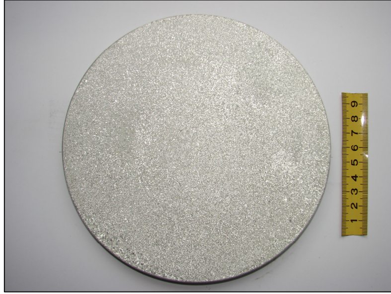
Şekil E.1.7 : Al%5Ti%1B mastır alaşıımı ilavesi yapılmamış alaşıma ait makro dağlama görüntüsü.
