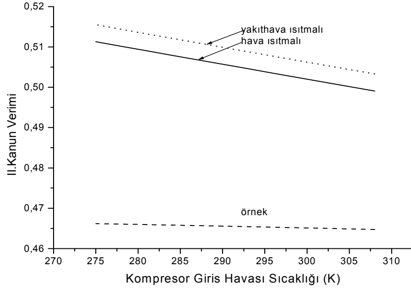
Şekil 4.15: Değişik kompresör giriş sıcaklıklarında örnek, hava ve yakıt hava ısıtmalı kojenerasyon çevrimlerinin II. Kanun veriminin hava fazlalık katsayısı ile değişimi ( m_{\text{yakıt}}=1,64 \text{ kg/s} , m_{\text{hava}}=91,3 \text{ kg/s} , h_{\text{fk}}=2,5 , \eta_{\text{izK}}=\eta_{\text{izT}}=0,86 , r=10 , T_{\text{rekçık}}=850 \text{ K} , T_{\text{buhar}}=485,57 \text{ K} , T_{\text{bacasıc}}=426 \text{ K} ).
