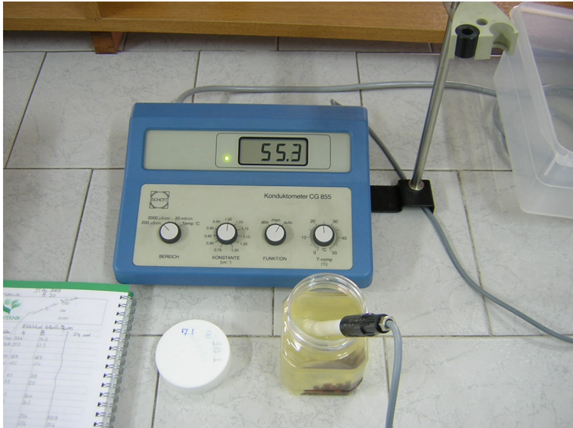
Şekil 3.2 Elektriksel iletkenlik okumaları sırasında kullanılan elektriksel iletkenlik ölçme aleti ve testte kullanılan kavanozlardan bir örnek
