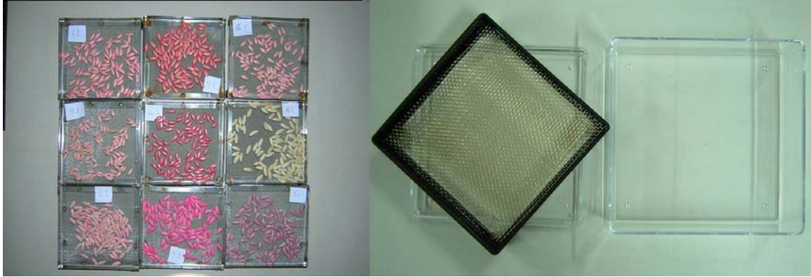
Şekil 3.6 Hızlı yaşlandırma testinde kullanılan yaşlandırma kaplarından bir örnek ve yaşlandırma sonrası hıyar tohumlarından görünüm
