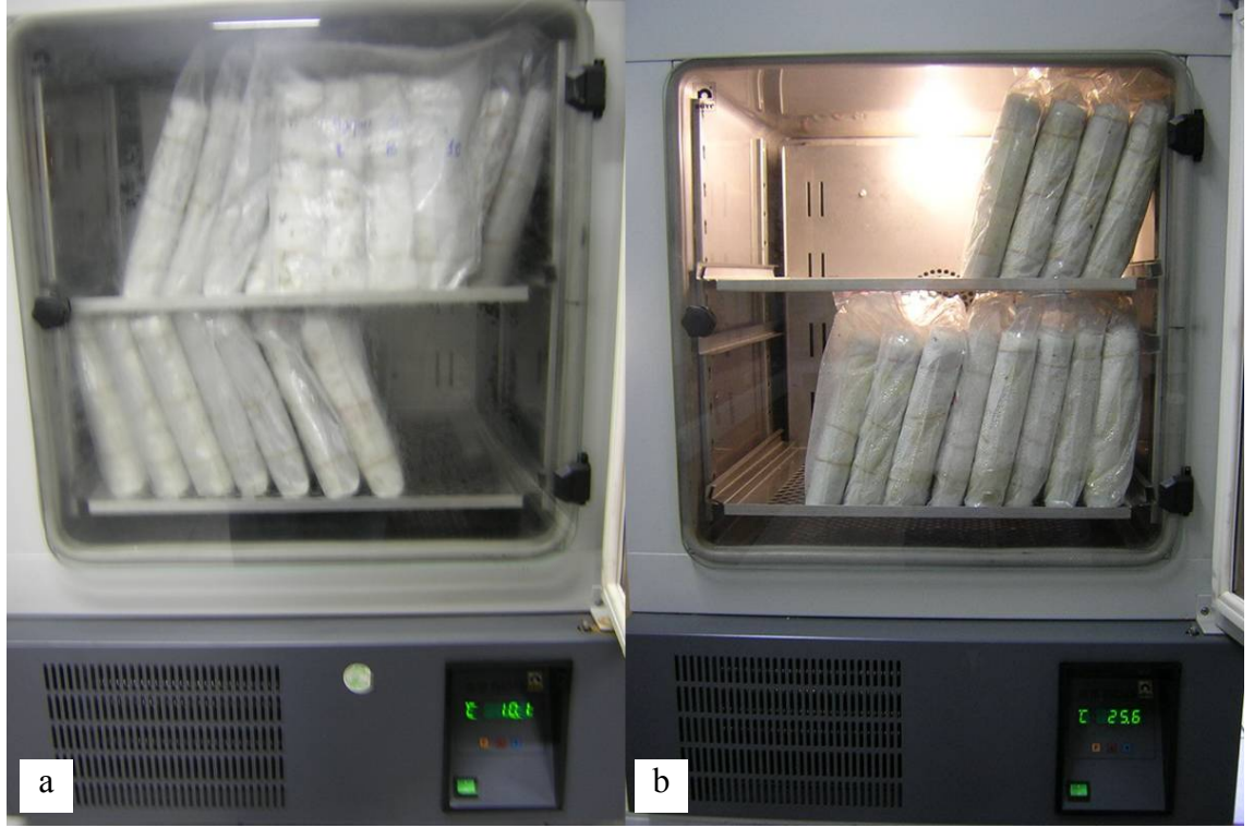
Şekil 3.4 Soğuk test birinci (10°C, a) ve ikinci (25°C, b) aşamalar sırasında tohum partilerinin iklim dolaplarındaki görünümü
