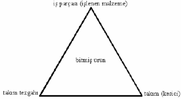
Şekil II.1 Takım Tezgâhı-Takım-İş Parçası İlişkisi
