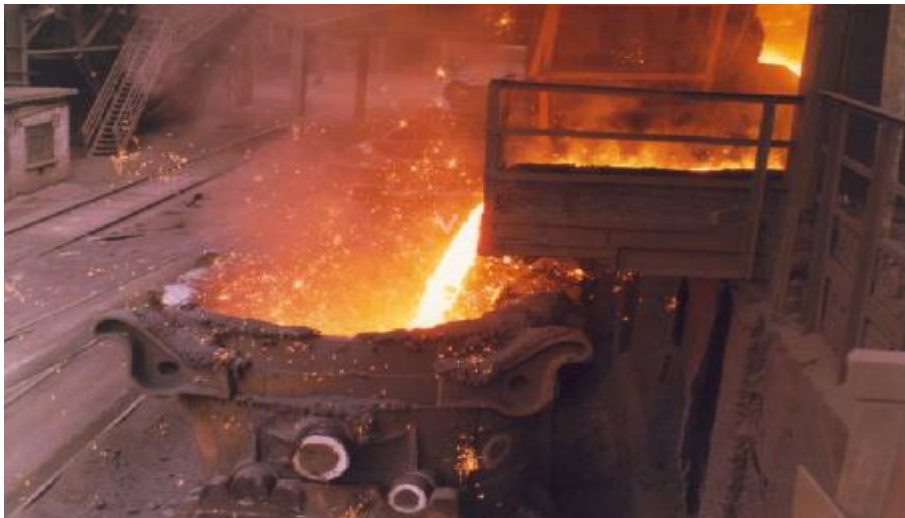
Şekil 1. 11. Yüksek Fırın ürünü sıvı madenin potaya alınışı
