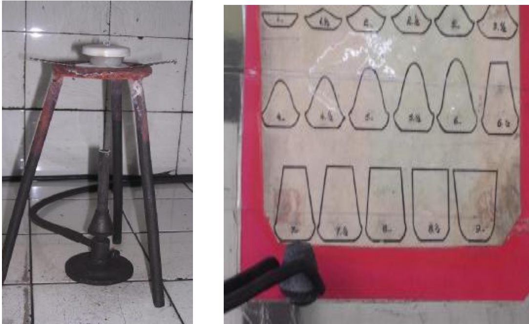
Şekil 3. 3. Serbest şişme indeksi (FSI) kroze, ısıtma beki ve karşılaştırma tablosu
