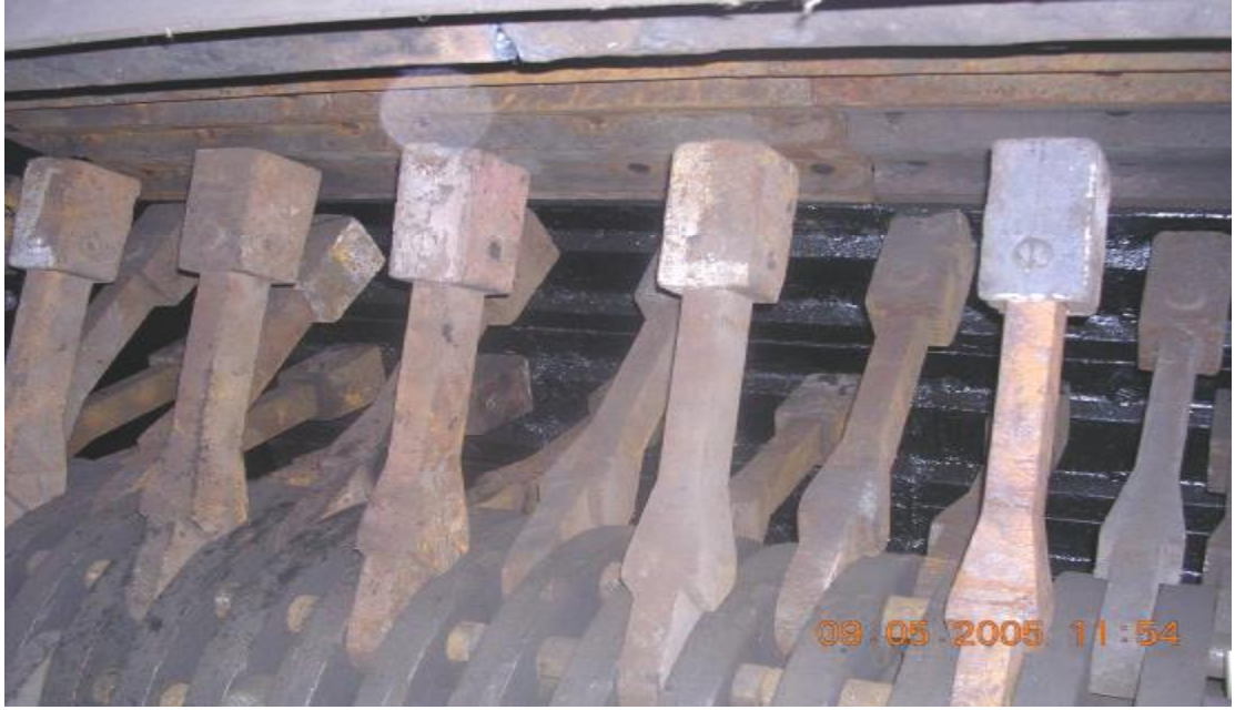
Şekil 1. 7. Çekiç kollu kırıcı, içyapısı
