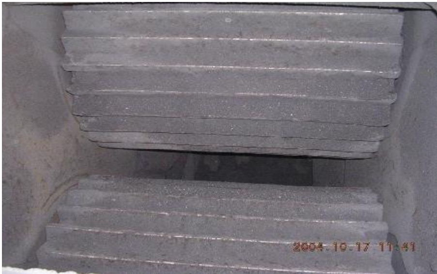
Şekil 1. 9. Silindirik kırıcı iç, yapısı
