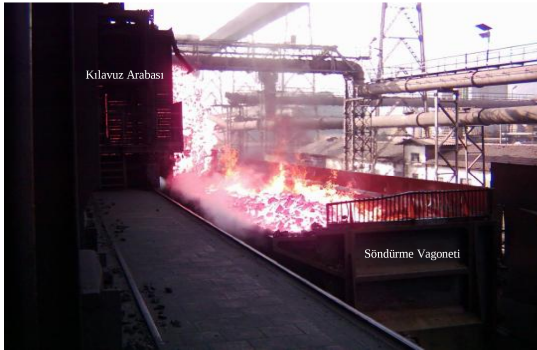
Şekil 1. 8. Kok fırınlarından kokun söndürme arabasına alınışı.
