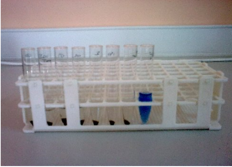
Ek Şekil 3. Adsorpsiyon Çalışması Sonrası Rengi Açılan Remazol Brilliant Blue Boyası
