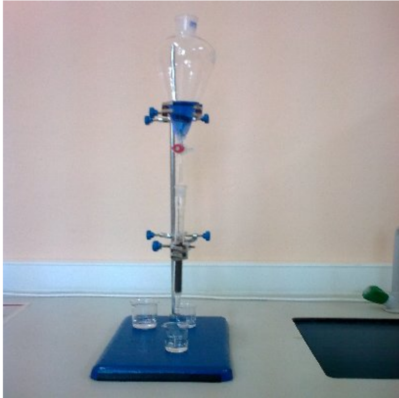
Ek Şekil 8. Kolon Adsorpsiyon Çalışması sonrası Rengi Açılan Remazol Brilliant Blue Boyası
