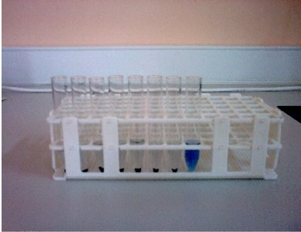
Ek Şekil 3. Adsorpsiyon Çalışması Sonrası Rengi Açılan Remazol Brilliant Blue Boyası
