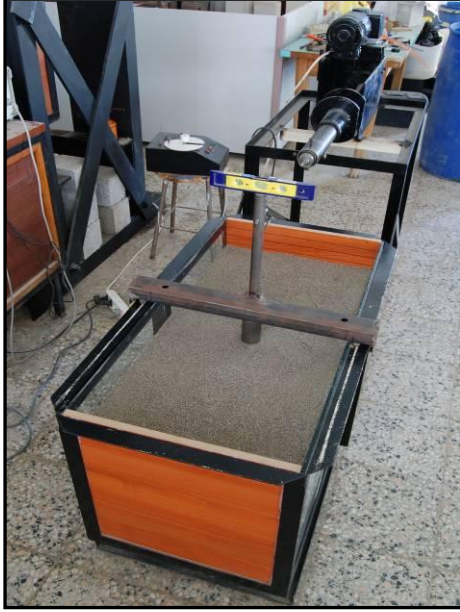
(g) Kazık Yerleştirildikten Sonra Zeminin Yerleştirilmesi
