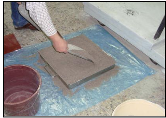
(b) Zeminin Kap İçerisine Yerleştirilmesi
