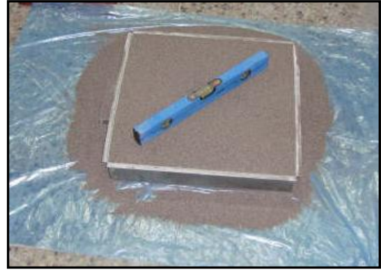
(d) Yüzey Düzlüğünün Kontrolü
