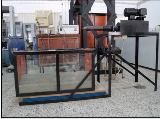
(a) Deney Kumunun Kasa İçerisine Konulması
