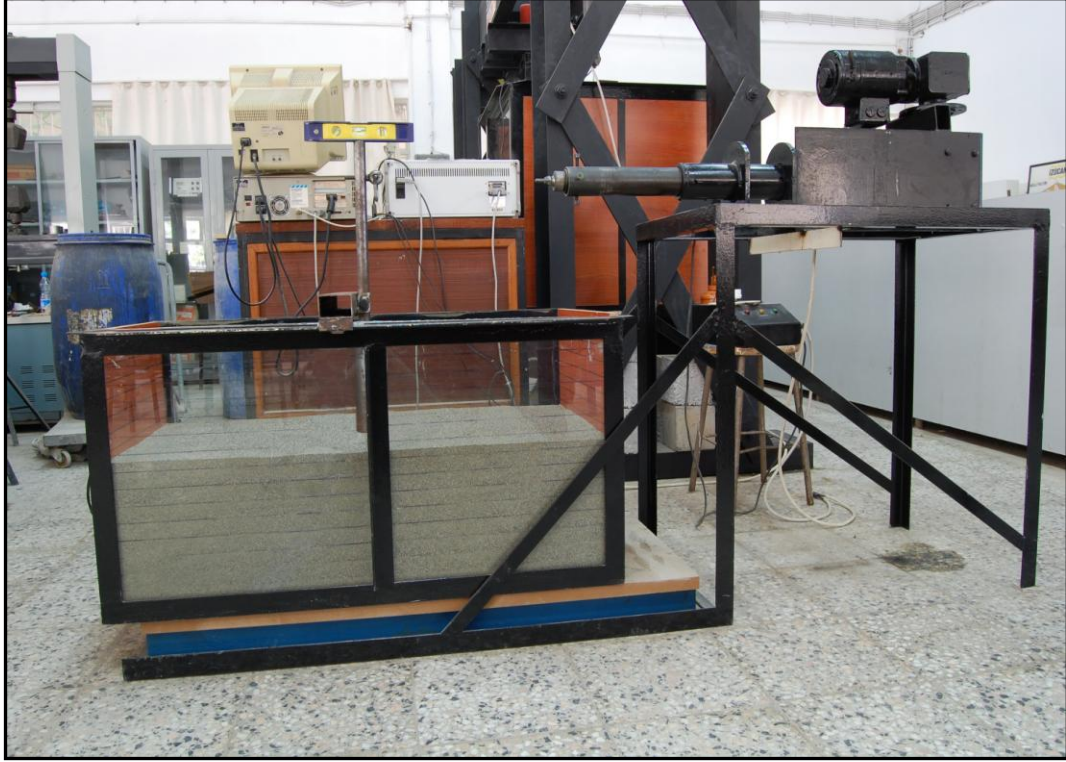
Şekil 3.8. Model Kazığın Zeminde Dik Konumda Tutulması
