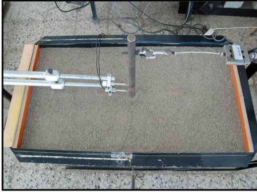
(i) Deplasman Transduserlerinin Yerleştirilmesi
