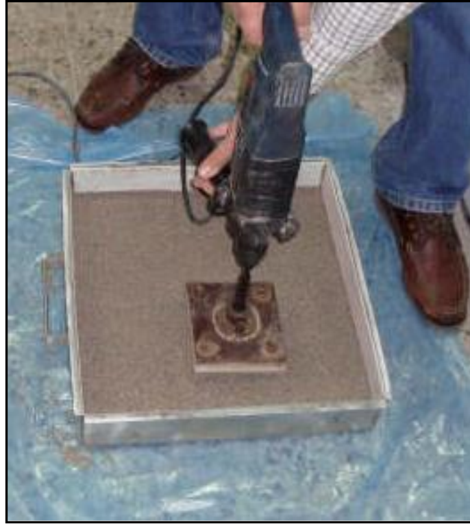
Şekil 3.13. Sıkı Kum Zeminin Kuru Birim Hacim Ağırlığının Belirlenmesi
