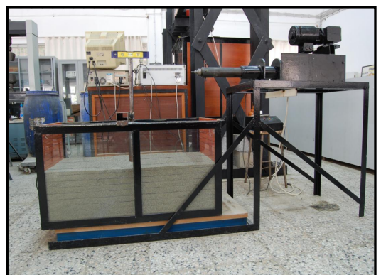
(f) Kazığın Yerleştirilmesi
