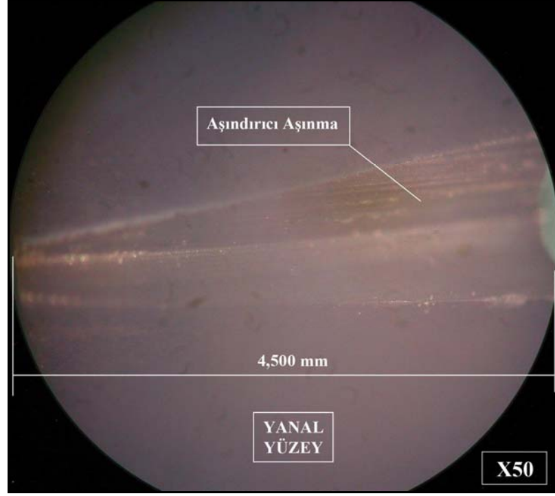
Şekil 4.1 Birinci deney serisinde ilk deneyinde meydana gelen kesici takım yanall yüzey aşınması
