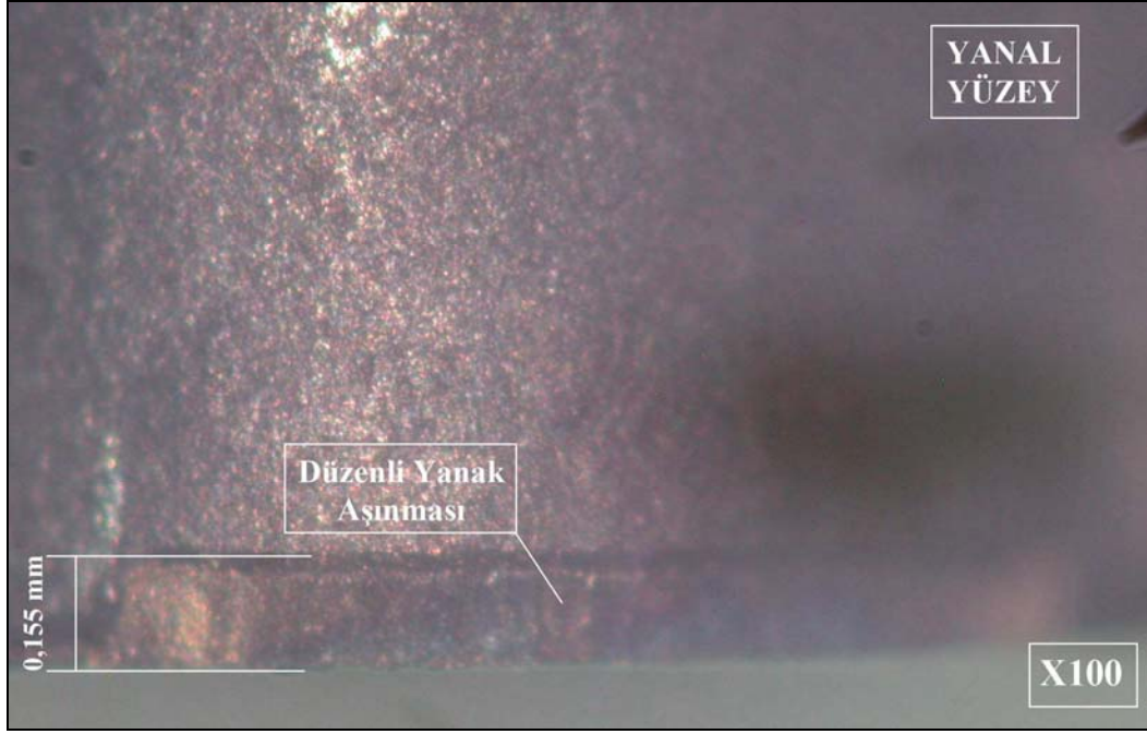
Şekil 4.22 Üçüncü deney serisinin yedinci deneyinde meydana gelen kesici takım yanıl yüzey aşınması
