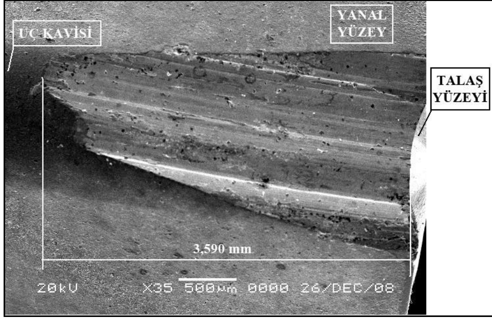
Şekil 4.42 Birinci deney serisinin ikinci deneyinde kullanılan kesici takımın elektron mikroskobundan elde edilmiş görüntüsü
