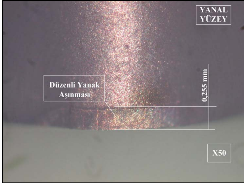
Şekil 4.17 Üçüncü deney serisinin ikinci deneyinde meydana gelen kesici takım yanal yüzey aşınması
