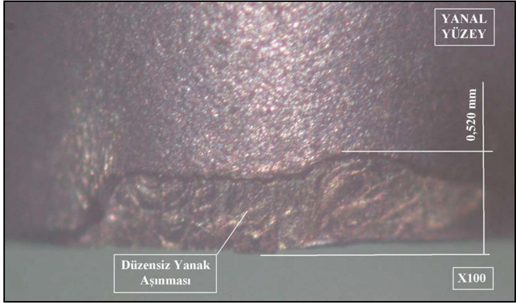
Şekil 4.18 Üçüncü deney serisinin üçüncü deneyinde meydana gelen kesici takım yanal yüzey aşınması
