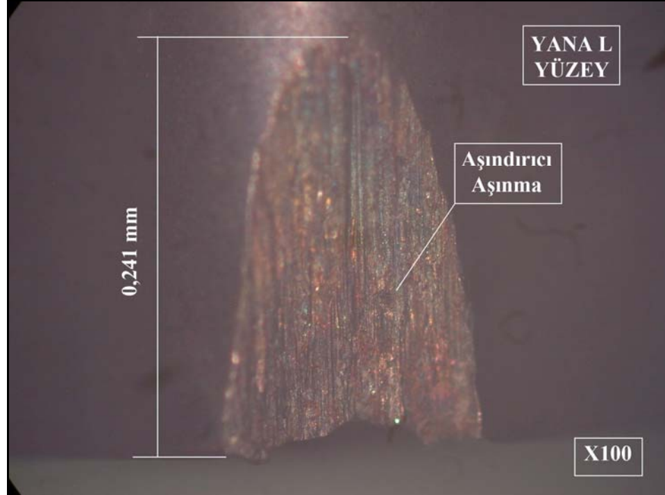
Şekil 4.8 Birinci deney serisinin dokuzuncu deneyinde meydana gelen kesici takım yanıl yüzey aşınması
