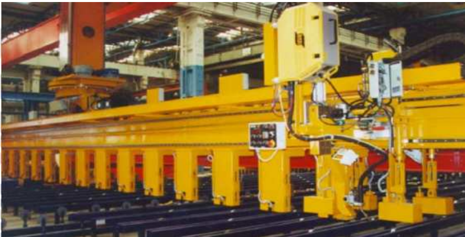
Şekil 2.3 Stiffiner köşe kaynaklarının özlü tel elektrodla kaynağı (Asarkaya, 2004)
