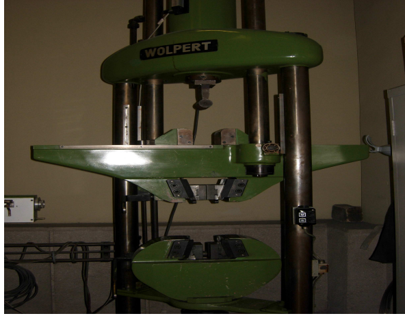
Şekil 3.22 WOLPERT marka 40 kN 'luk üniversal çekme cihazı
