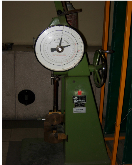
řekil 3.25 WOLPERT marka 300 J'luk entik darbe deneyi cihazı
