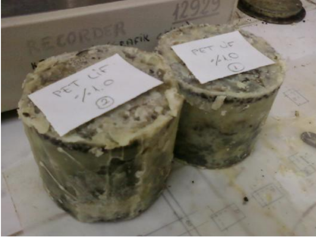
Şekil 3.31. Parafinle Kaplanmış Marshall Numuneleri
