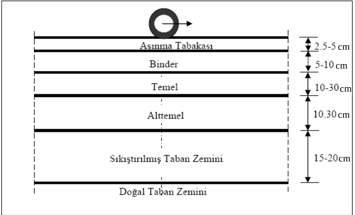
Şekil 1.3. Tipik Esnek Üstyapı Tabakaları (Karaşahin ve diğ., 1997)
