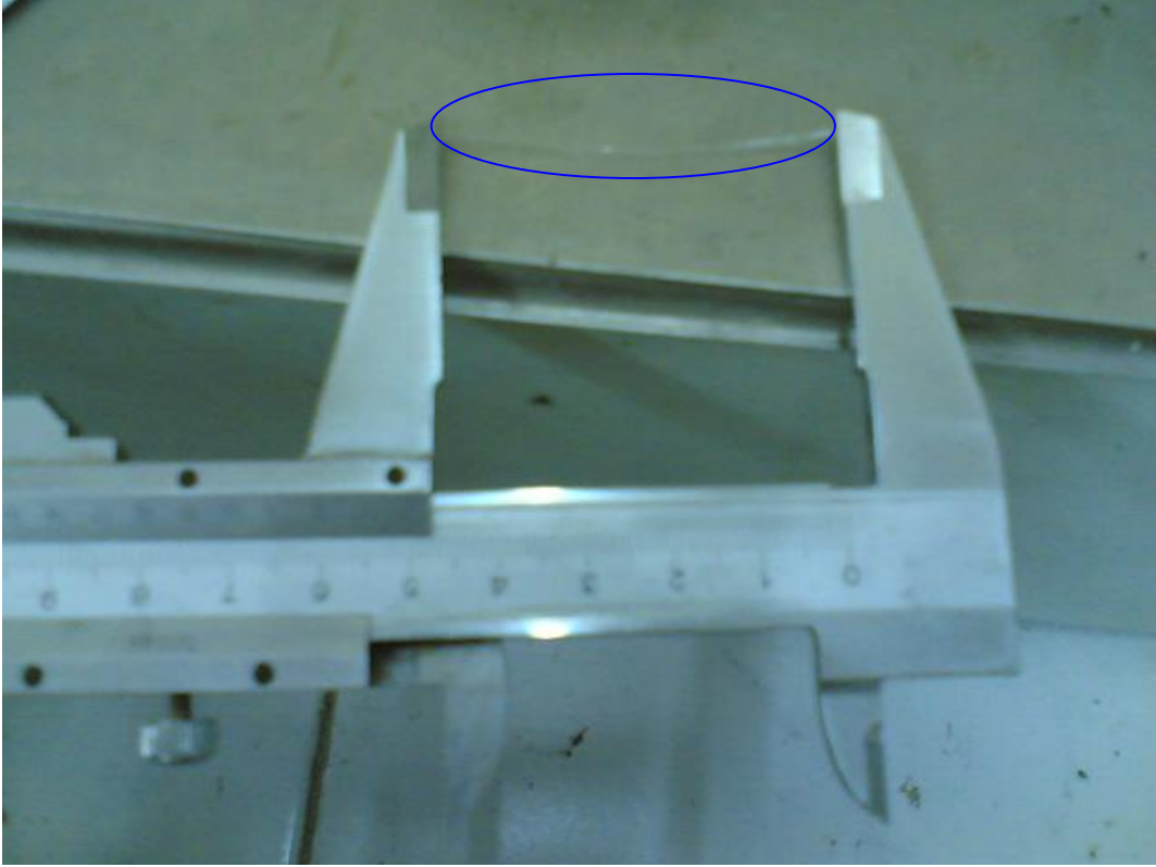
Şekil 3.10. Kalınlığı \approx 0,7 mm, Uzunluğu 30\pm 1 ila 50\pm 1 mm Olarak Kesilmiş PET Lif
