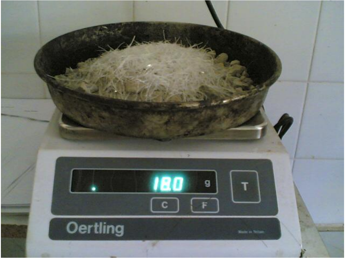
Şekil 3.26. Asfalt Karışımına PET Lif Katılması
