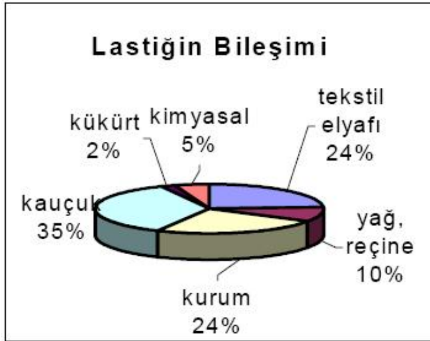
Şekil 3.12. Lastiğin Bileşimini Oluşturan Malzeme Yüzde Dilimleri
