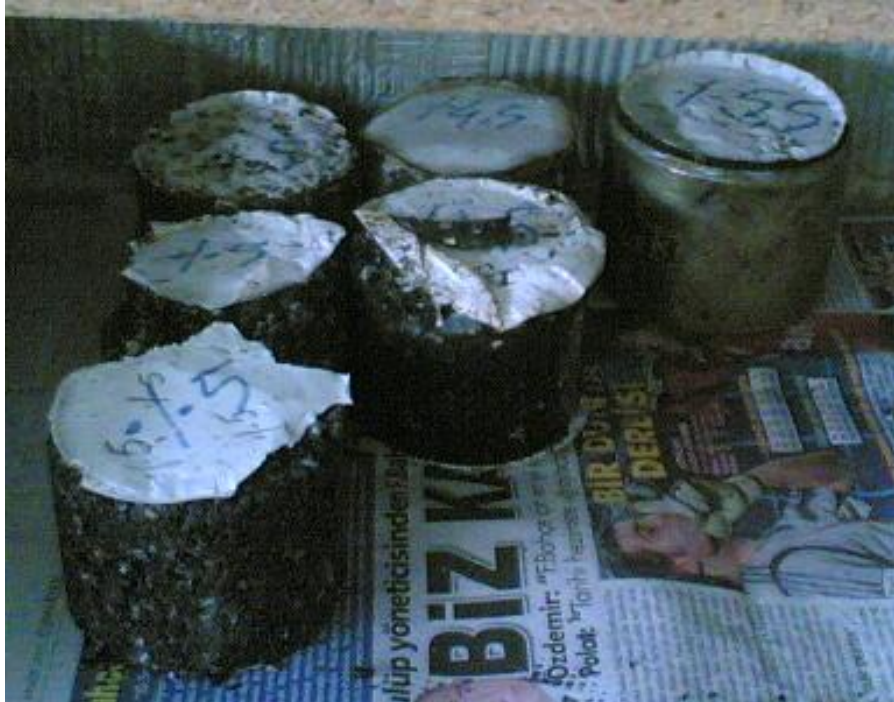
Şekil 3.22. Optimum Bitüm Muhtevasını Belirlemek İçin Hazırlanan Bir Grup Numuneler
