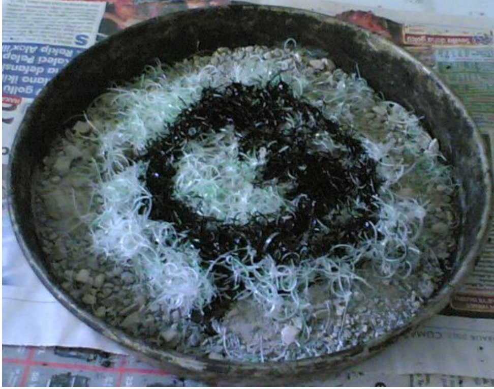
Şekil 3.27. Asfalt Çimentosu İlave Edilmesi
