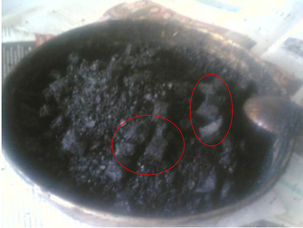
Şekil 3.24. Agregada Gradasyonunda İri Agregaya Yerine Otomobil Lastiği Katılan Asfalt Karışımı
