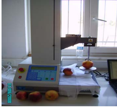
Şekil 3.8. Meyvelerin sertlik ölçümünden görüntüler
