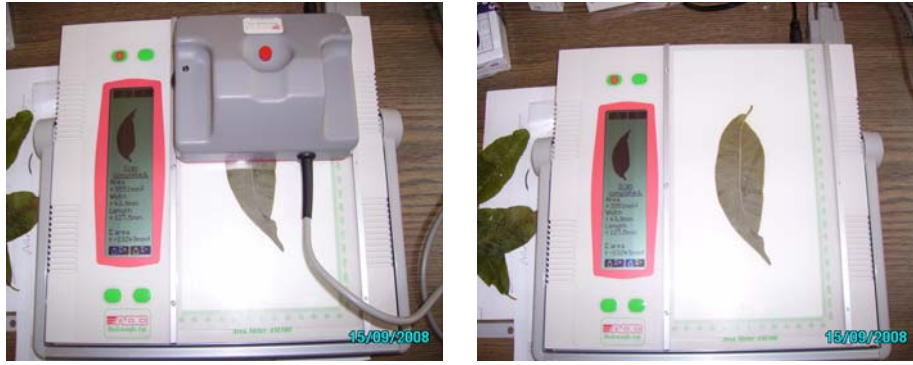
Şekil 3.14. Optik alan ölçer ve yaprak ölçümü görüntüleri
