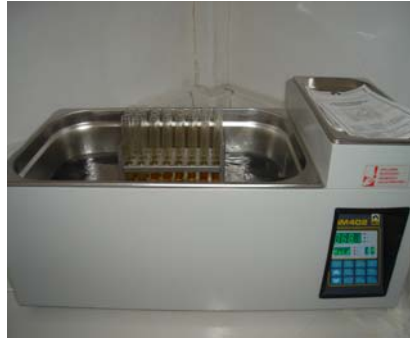
Şekil 3.13. Toplam şeker, invert şeker ve sakkaroz miktarı ölçümler için hazırlana ekstraktların sıcak su banyosunda bekletilmesinden ve spektrofotometrede okunmasından görüntüler
