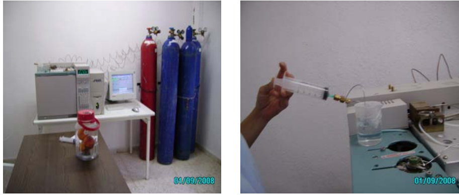
Şekil 3.12. Gaz kromatografisi ve meyvelerin etilen ve solunum hızı ölçüm görüntüleri
