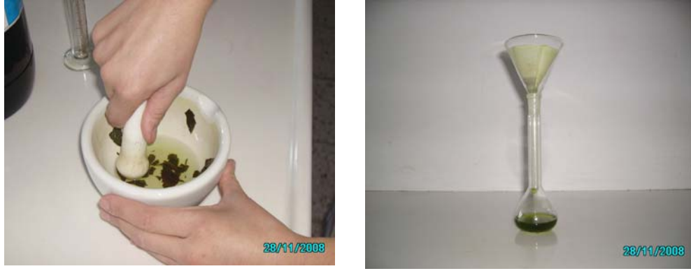
Şekil 3.15. Yaprak örneğinin porselen havan içerisinde, 20 ml % 80' lik aseton ile homojenize edilerek 50 ml' lik ölçü balonuna süzülme işlemi
