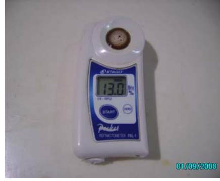
Şekil 3.10. Meyve suyunda SÇKM ve TA ölçümlerinin görüntüleri
