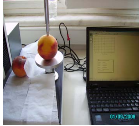
Şekil 3.8. Meyvelerin sertlik ölçümünden görüntüler
