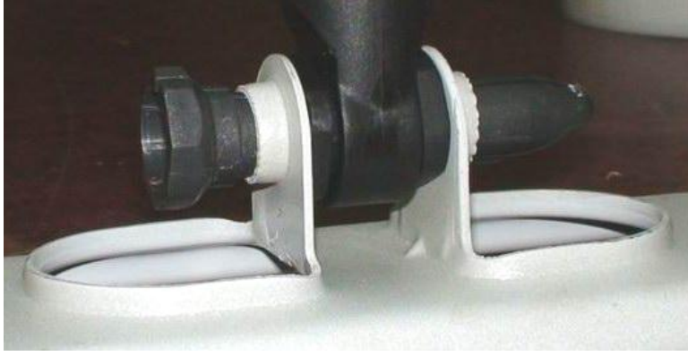
Şekil 4.4 : Amortisörün plastik pim vasıtasıyla çelik şase parçasına montajı.
