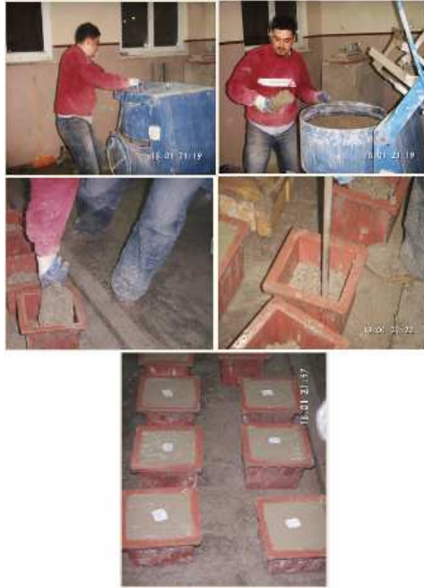
Şekil 3.2 Taze betonun karıştırılması, kalıba yerleştirilmesi, sıkıştırılması ve perdahlanması işlemleri
