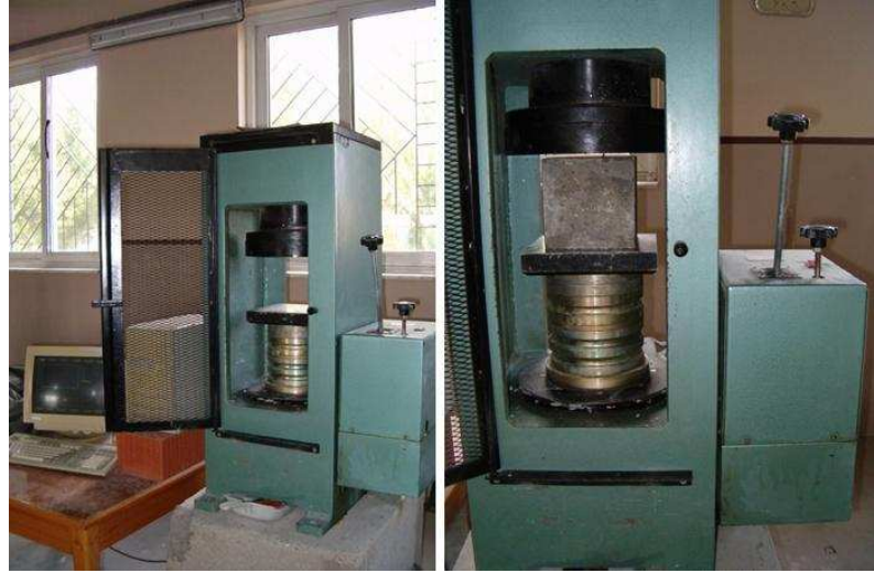
Şekil 3.3 200 ton kapasiteli hidrolik deney presi
