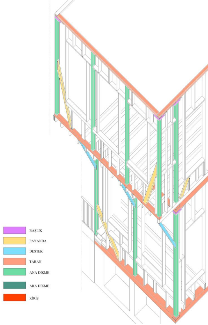
Çizim 3.1 Bölgeye ait genel bir taşıyıcı sistem şeması örneği
