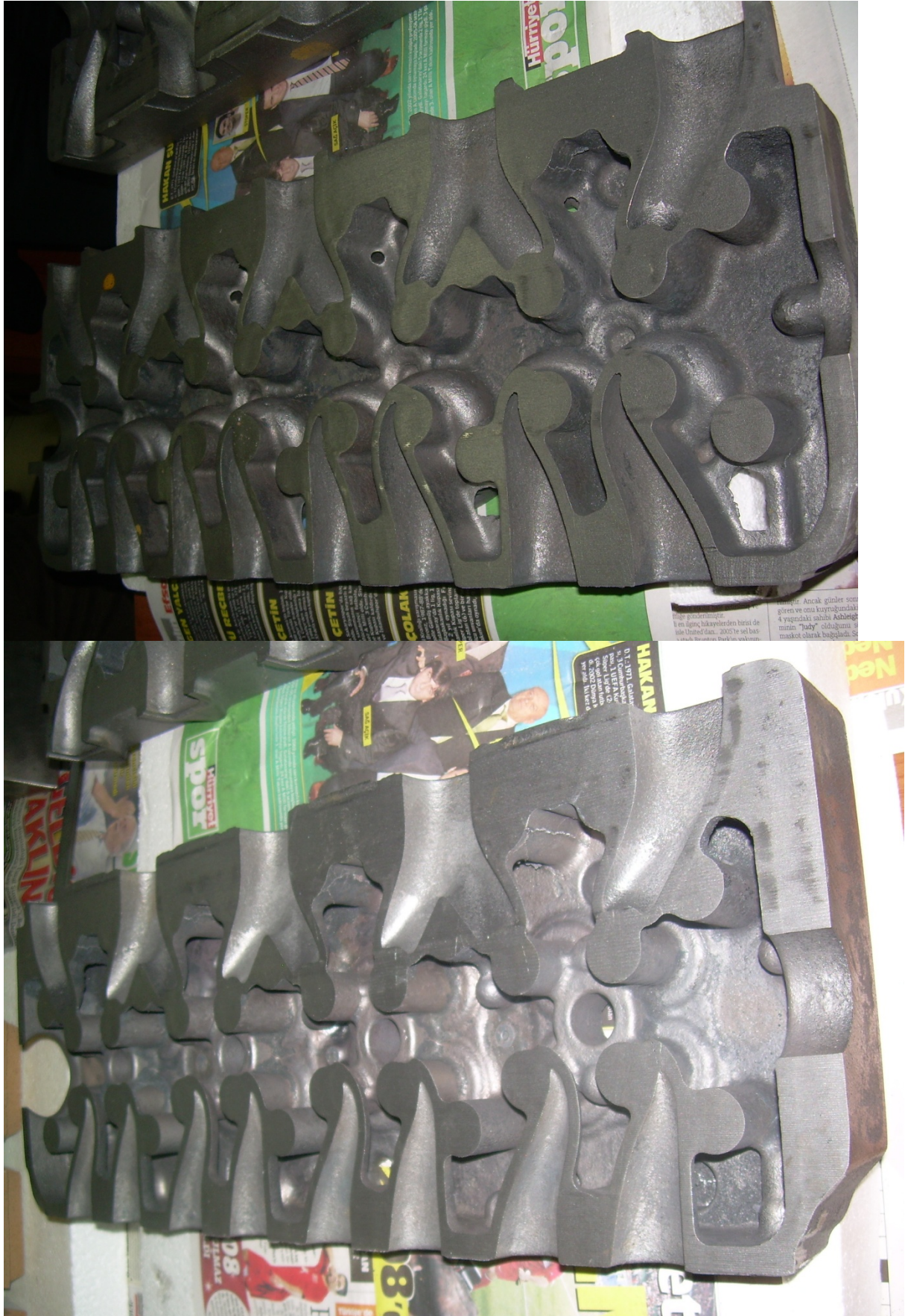
Şekil D.2 : Silindir kafası döküm ürününün üst ve alt kesitleri
