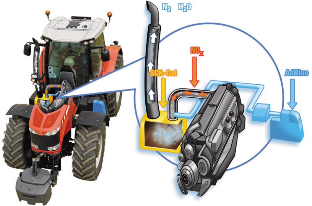
Şekil 2.18 : Üre katkılı seçici katalitik indirgeyici şematik çalışma prensibi ve traktör üstünde yerleşimi
