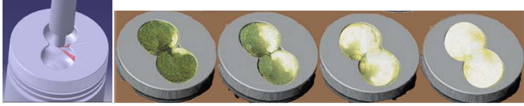
Şekil 3.16 : İki Döngülü MR-2 Yanma Odasında Gerçekleşen Yakıt Püskürtme ve Yanma Süreçlerinin Şeması
