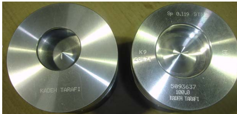
Şekil 3.10 : TÜMOSAN Dizel Motorları Ailesinin Pistonlar Üzerinde Standart (sağda) ve MR-1 Yanma Odalarının Fotoğrafları
