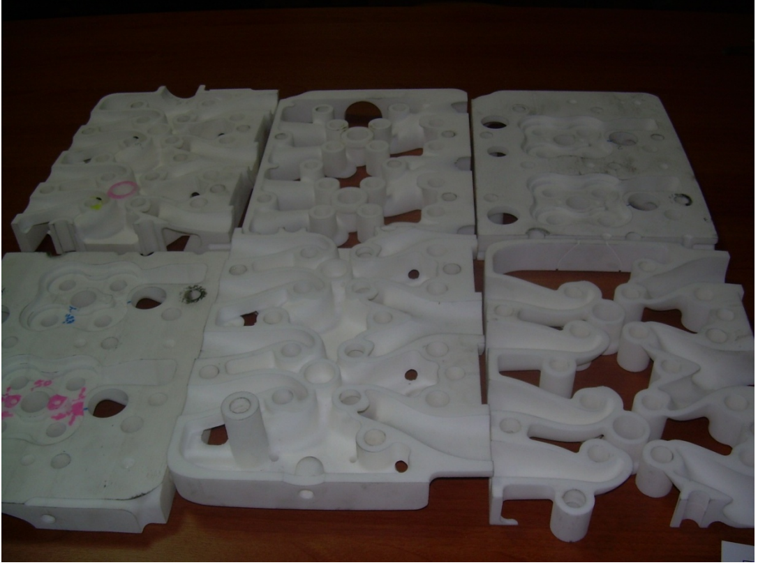
Şekil D.3 : Silindir kafasının hızlı prototip ürününün kesitleri
