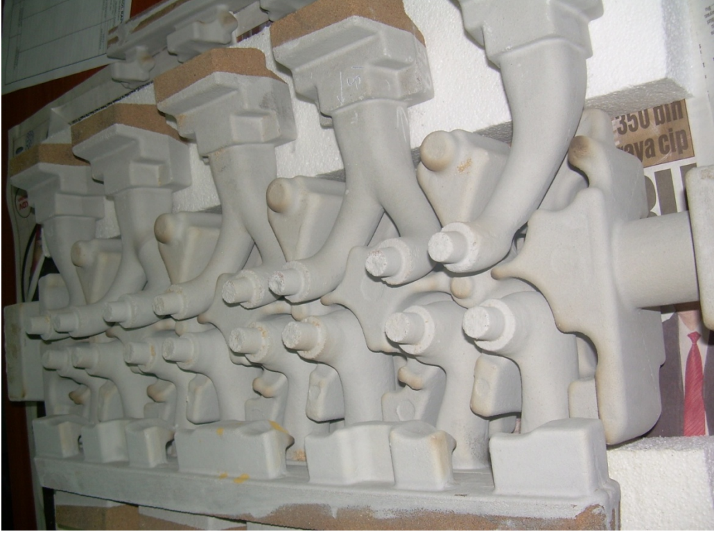
Şekil D.1 : Silindir kafasının soğutma suyu kanalı, egzoz kanalı ve emme kanalı maçaları
