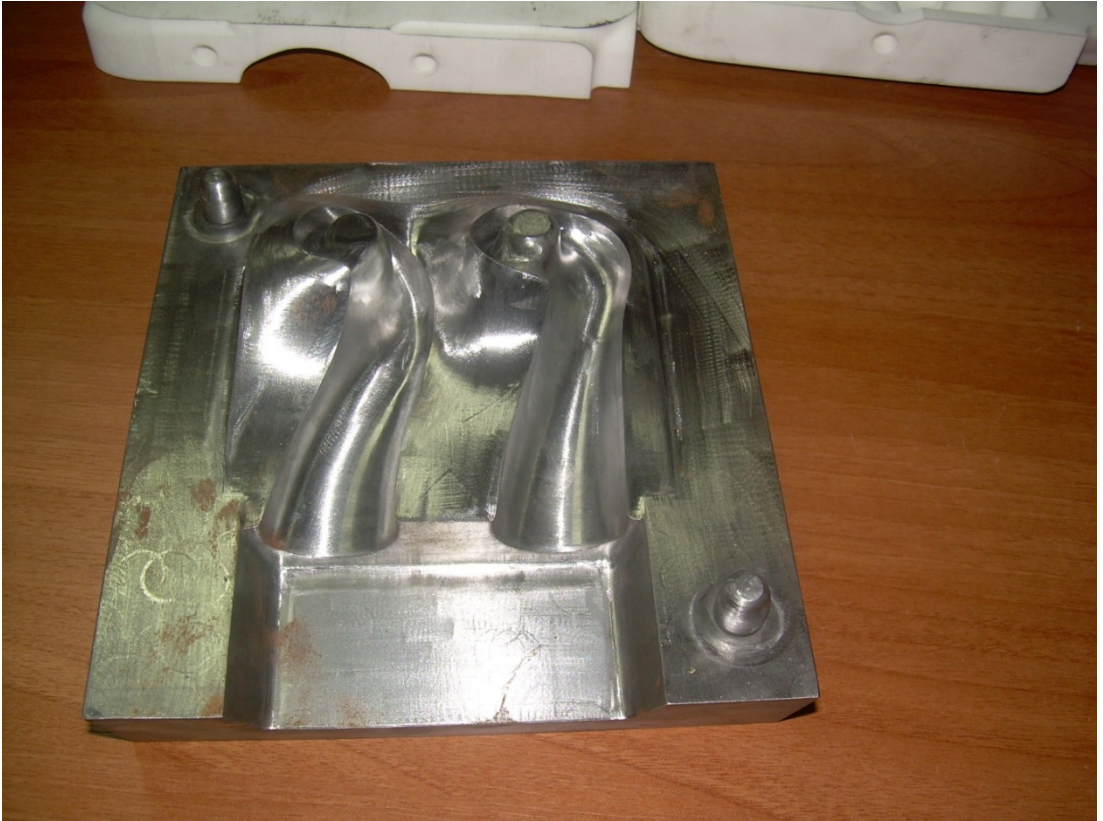
Şekil D.4 : Emme kanalı maçası için CNC tezgahta işlenmiş maça kalıbı
