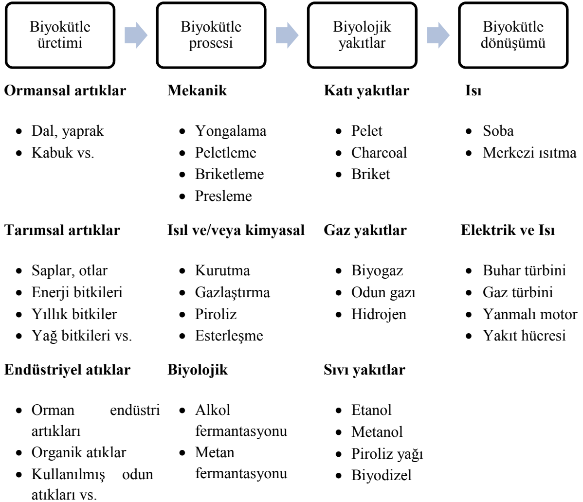
Şekil 1.9. Biyokütle kaynağının enerji ve yakıt ürünleri amaçlı çok yönlü kullanımı (Chum ve Overend, 2001).
