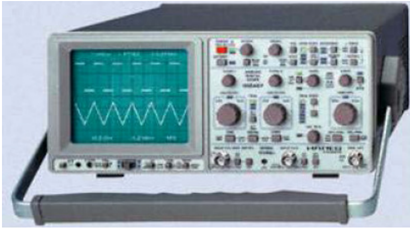
Şekil 1.3 : 150 MHz analog/dijital CRT osiloskop (fiyatı $3150).
