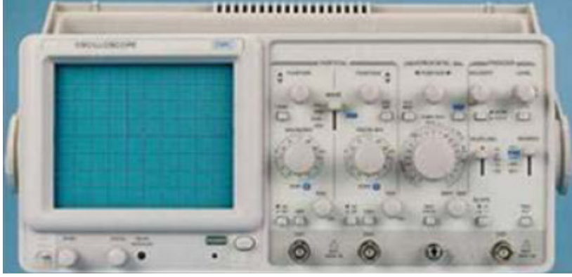
Şekil 1.2 : 20 MHz çift kanallı CRT osiloskop (fiyatı $800).
