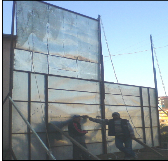
Şekil 4.5 Düşey yansıtıcı yüzey.
