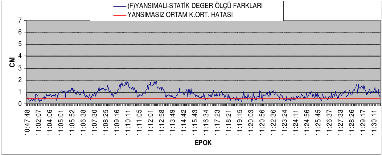
Şekil 4.26 Yansımali ölçü grubu ile yansimasiz ortam karesel ortalama hatası.
