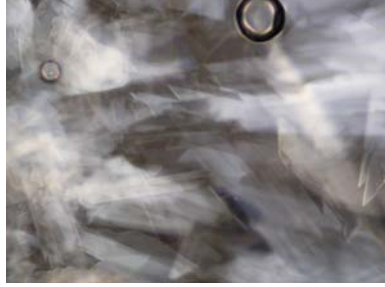
Şekil 6.1. %50DTAB+%50 etil alkol için liyotrop hegzagonal fazın fan tekstürü ( x100 büyütme, beyaz ışık, T=297\text{ K} )
