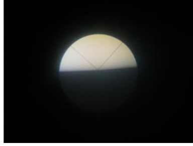
Şekil 5.4 Abbe Refraktometresi aydınlık-karanlık bölge ( http://tr.wikipedia.org/wiki/Refraktometri 9.10.2008)
