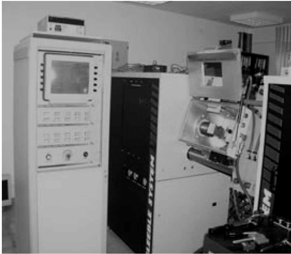
Şekil 3.2 Termal-mekanik test ve simülasyon cihazı.
