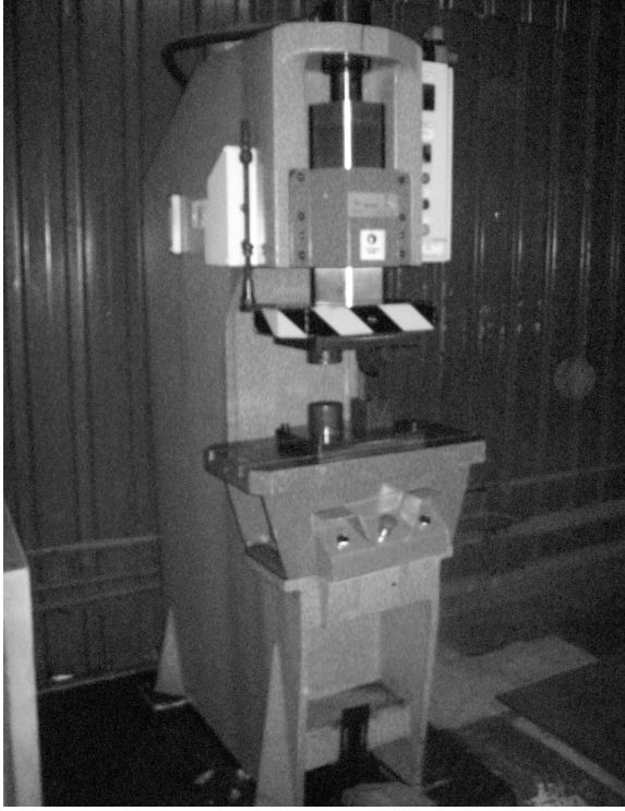
Şekil 3.10 60°V bükme test cihazı ve bükme-doğrultma kalıpları.
