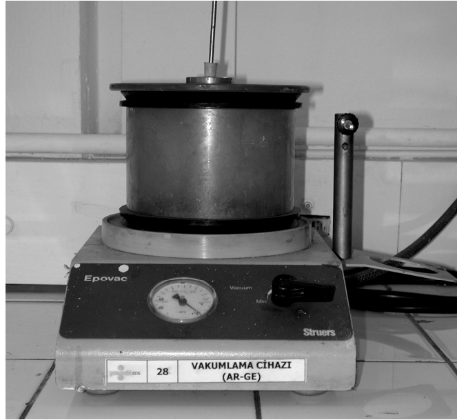
Şekil 3.6 Vakum altında sođuk kalıplama cihazı.
