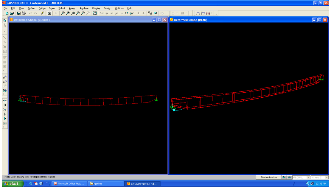
Şekil 7.11: İkinci durumda ana kirişte oluşan sehim
