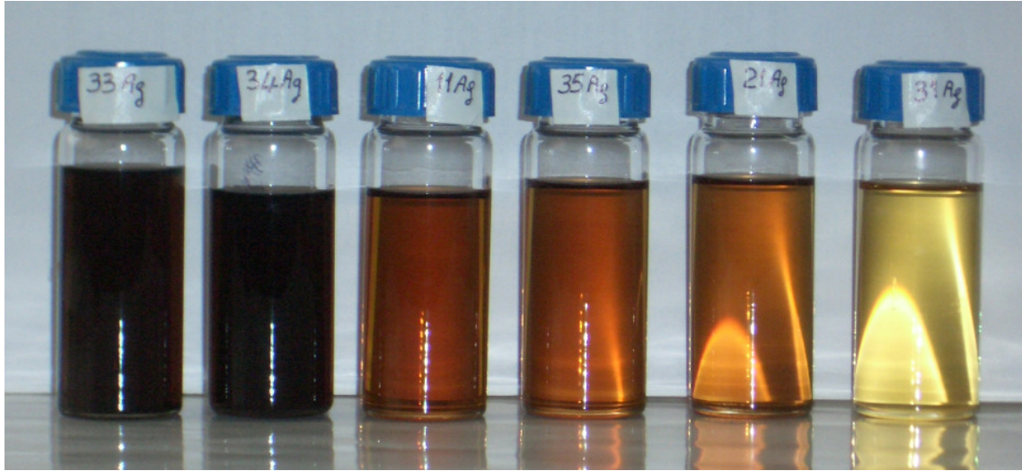
Şekil 5.4 Farklı mol oranlarında sentezlenmiş koloidal Ag nanoparçacıkları içeren PP-g-PEG hibrit yapı.
