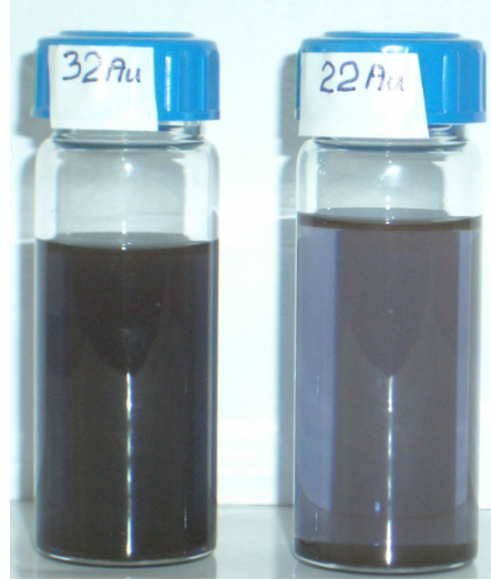
Şekil 5.7 Farklı mol oranlarında sentezlenmiş koloidal Au nanoparçacıkları içeren PP-g-PEG hibrit yapı.
