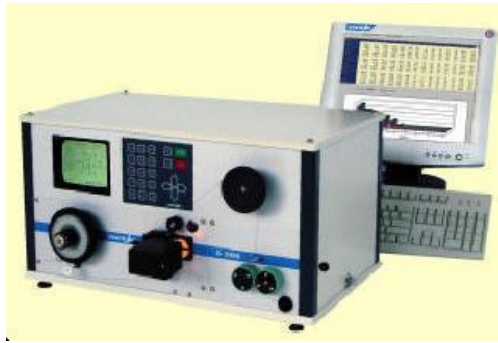
Şekil 3.4 Tüylülük test cihazı ( www.erlermakina.com , 2009)
