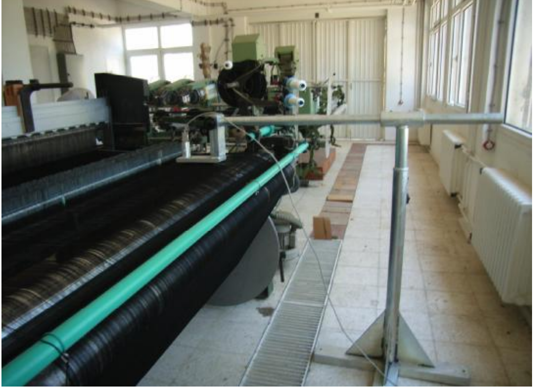
Şekil 3.16. Gerilim ölçme cihazı ve takıldığı stand
