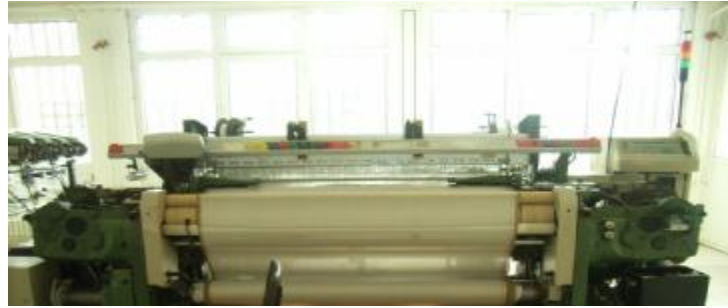
Şekil 3.1. Picanol GTX dokuma makinası
