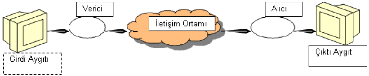
Şekil 3: Temel Telekomünikasyon İletişimi Sistemi
