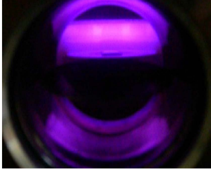
Şekil 6.3 : RF-KBB sistemi ile üretilen plazma.
