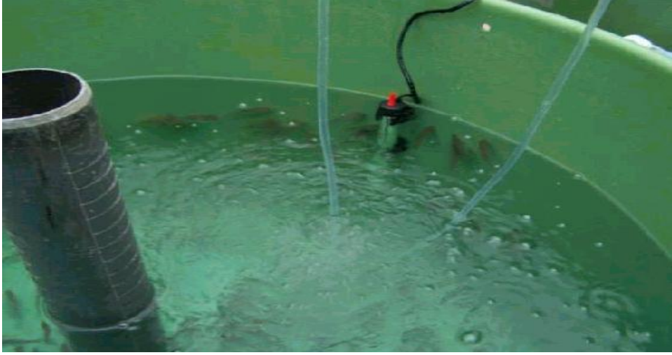
Şekil 3.5. Deneme Tankları ve ısıtıcıların yerleştirilişi şekli
