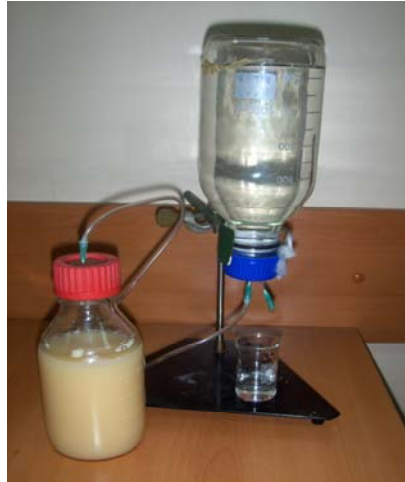
Şekil 6.48 Oluşan gazın direk olarak toplanması
