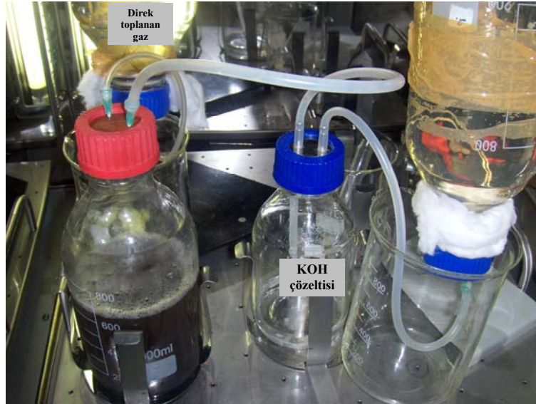
Şekil 6.50 KOH çözeltisinden geçirilerek ve geçirilmeden yapılan ikili gaz toplama sistemi
