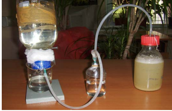
Şekil 6.49 Oluşan gazın %37'lik KOH çözeltisinden geçirilerek toplanması
