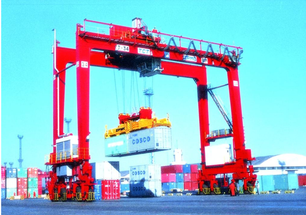
Şekil 1.5 : Konteyner istiflemeye kullanılan kutu kirişli, lastik tekerlekli kren.
