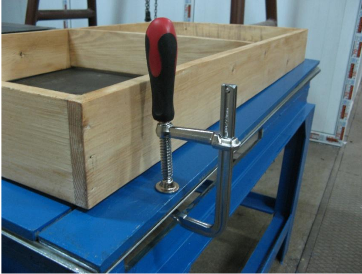
Şekil 3.5 : El tipi işkence ile kenar sabitleme.
