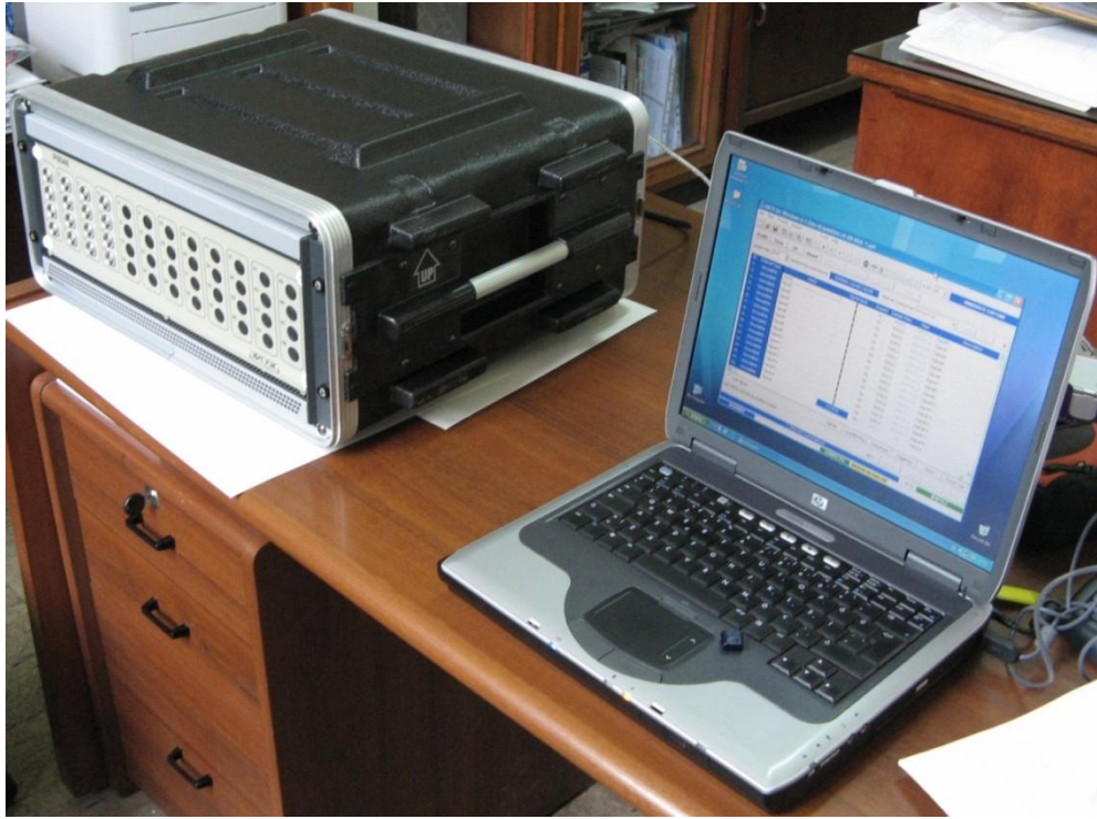
Şekil 3.10 : Veri toplama ve sinyal işleme sistemi.
