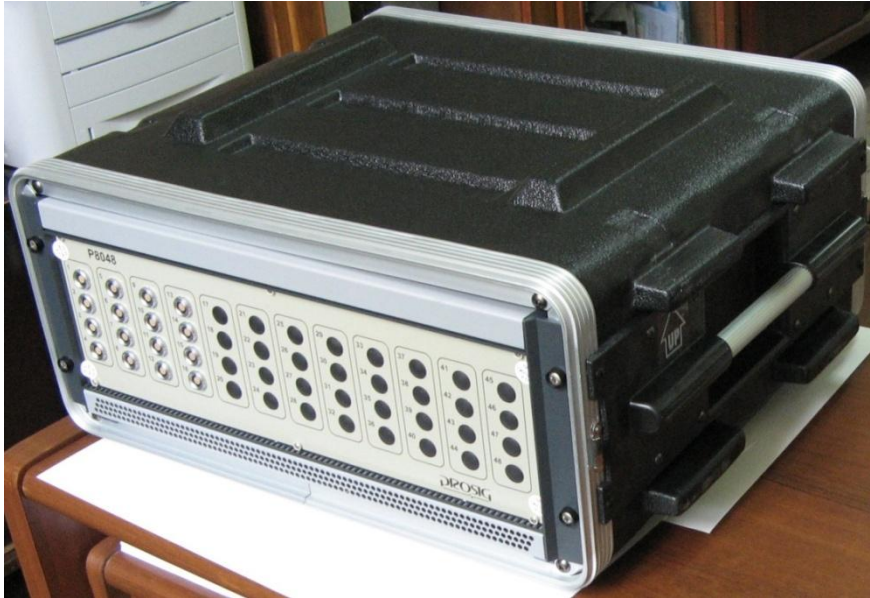
Şekil 3.9 : Prosig 16 kanallı veri toplama cihazı.
