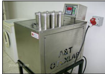
Şekil 4.23. Yıkama Haslığı Test Cihazı
