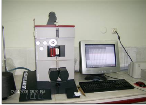
Şekil 4.3. Uster Tester 4-SX
