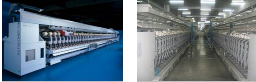
Şekil 3.23. Schlafhorst 338 (Schlafhorst, 2007) ve Murata 7-V Bobin Makinesi
