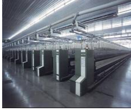
Şekil 3.10. Rieter G 30 ring iplik eğirme makinesi
