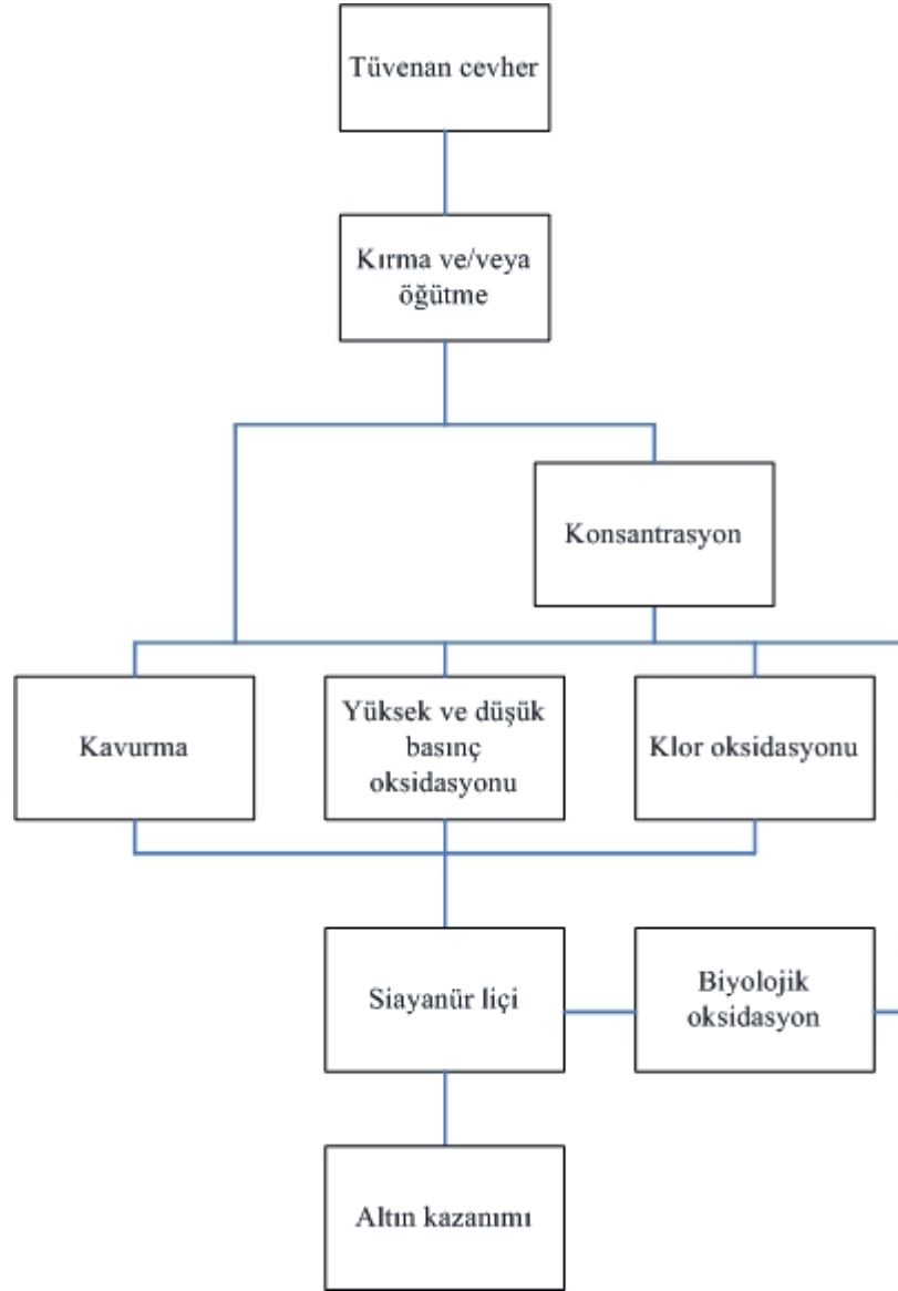
Şekil 2.7 : Refrakter altın cevherlerinin üretim prosesleri [2].
