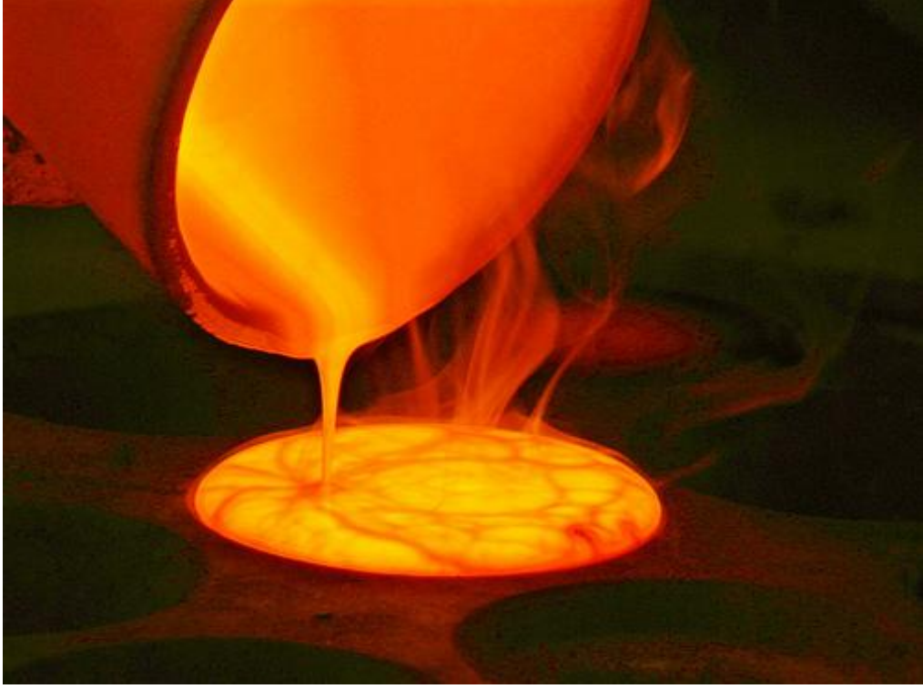
Şekil 3.2 : Ateş analizinin ergitme kademesi [26].
