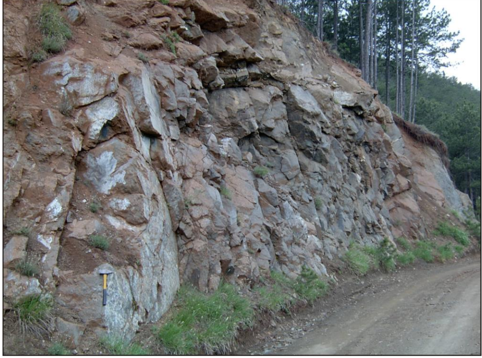
Şekil 4.20: Harzburjitleerde gözlenen eklem takımları [71485/32158].
