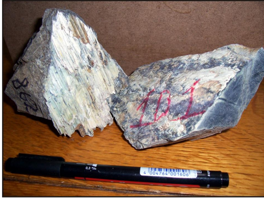
Şekil 4.67: Serpantin ; yeşilimsi mavi renkte yılan derisi benzeri dış görünümü ve kayma düzlemlerinde gelişen asbest mineralleri; (Ör.No: 862,101).
