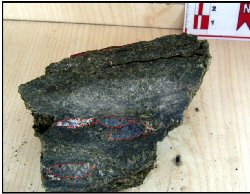
Şekil 4.44: Mika-kuvars şist ; kısmen belirgin ardalanma ve mikalı seviyeler arasındaki kuvars gözleri; (Ör. No:582).
