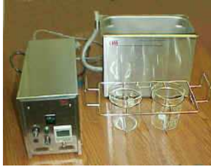
řekil 3.16: Yanıcı özelti kullanılan bir temizleme sistemi düzeneėi [13]
