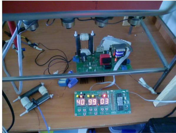
Şekil 5. 8: Mikrodenetleyicili kontrol kartı ve güç devresi
