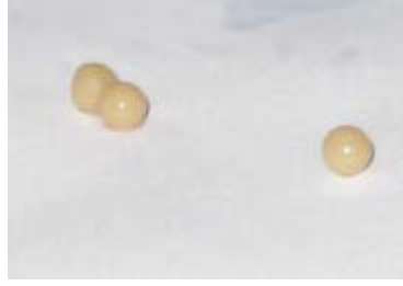
Şekil 2.2: Elde edilen Termamyl® immobilize edilmiş kitosan boncukları.
