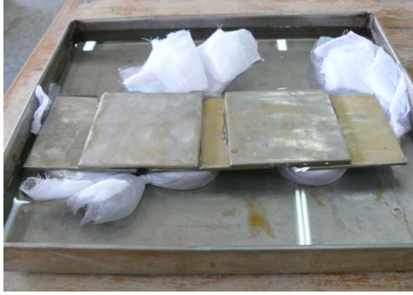
Şekil 3.19. Deneyde kullanılan referans numunelere tekrarlı şişme-büzülme uygulanması
