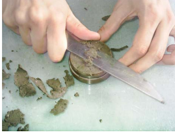
Şekil 3.18. Deney numunesinin hazırlanması
