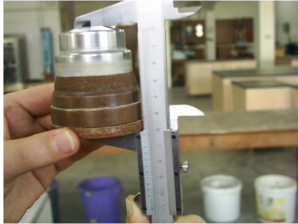
Şekil 3.20. Etüvden çıkan numunenin boyunun ölçülmesi
